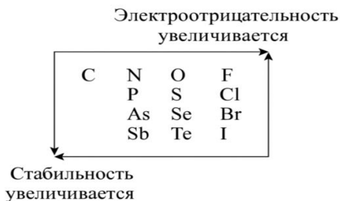
Рисунок 4.8 – Зависимость стабильности комплекса от электроотрицательности атома-донора лиганда [107]
