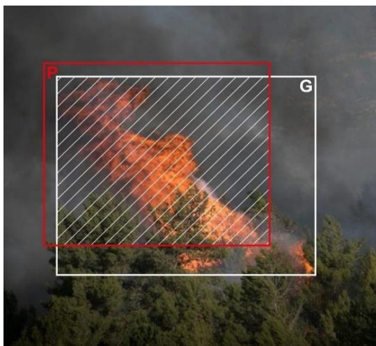
Рисунок 3.4 – Расчет IoU между реальным (G) и обнаруженным результатом (P)
