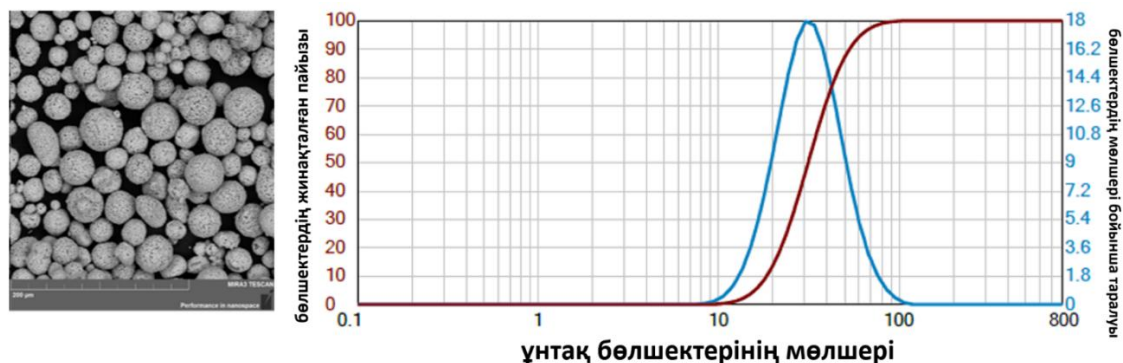
Сурет 2.1 – Бөлшектердің морфологиясы және ұнтақтың бөлшектердің мөлшерінің таралуы \text{Cr}_3\text{C}_2\text{-NiCr}
