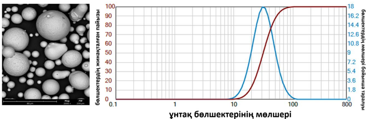
Сурет 2.2 – Бөлшектердің морфологиясы және ұнтақтың бөлшектердің мөлшерінің таралуы Fe-TiB 2 -CrB 2
