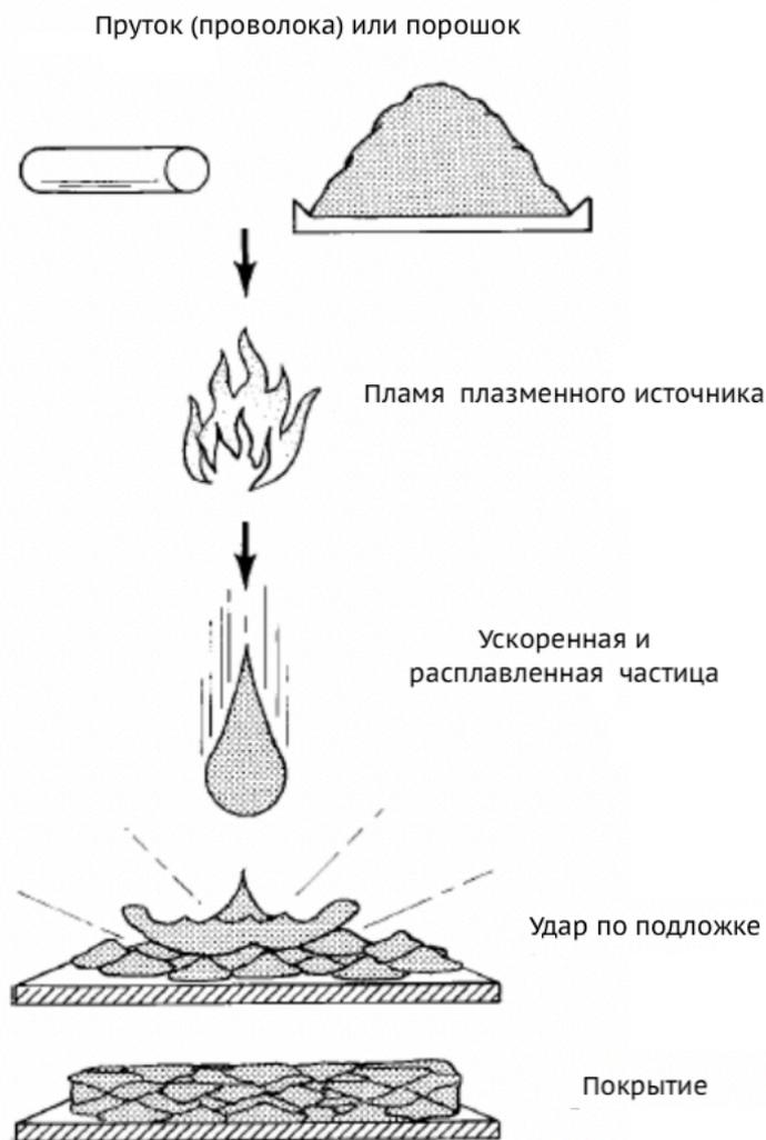
Рисунок 1.5 - Схема формирования газотермического покрытия
