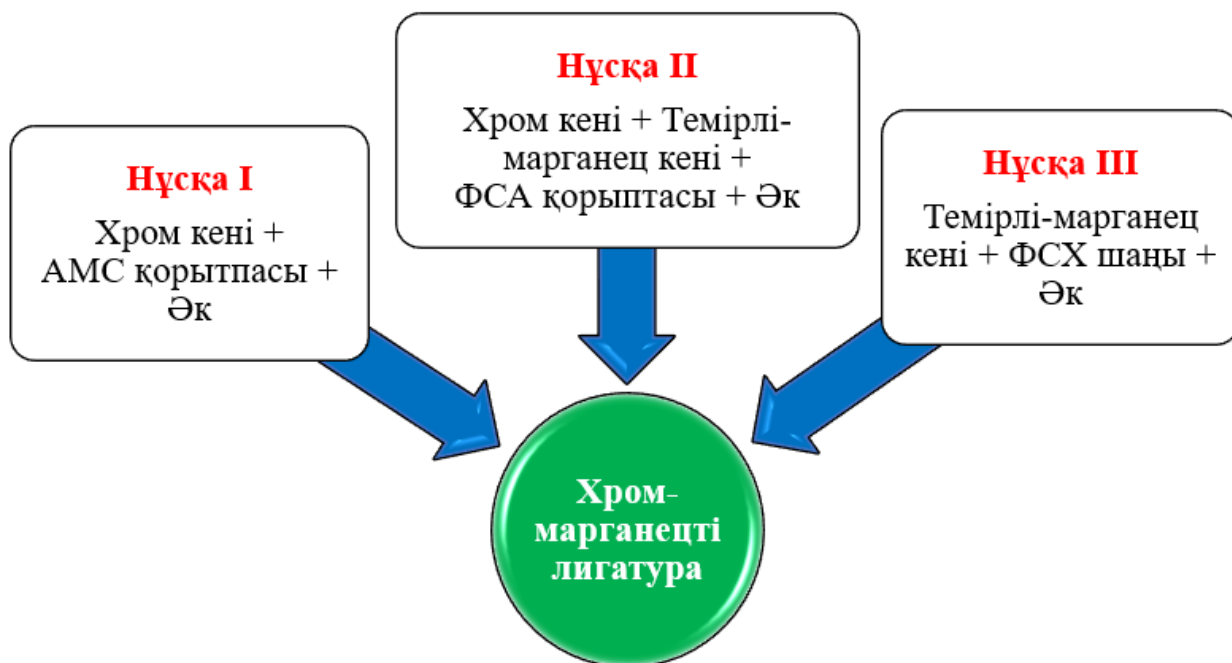
Сурет 3.1 - Әртүрлі тотықсыздандырғыштар қолданылған шикіқұрам нұсқалары
