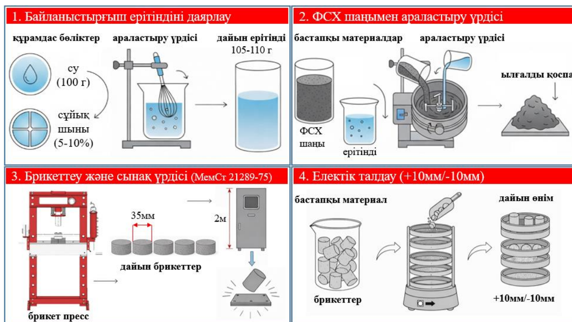
Сурет 4.18 – ФСХ шаңынан брикет дайындау технологиясының сұлбасы
