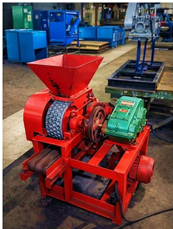
Сурет 4.19 – Жартылай өндірістік типті «JZQ250» маркалы брикеттеу машинасының құрылымдық сұлбасы және өндірістік үлгісі: 1 – бункер; 2 – пресстеу білігі; 3 – электрқозғалтқыш; 4 – редуктор; 5 – шығару конвейері.
