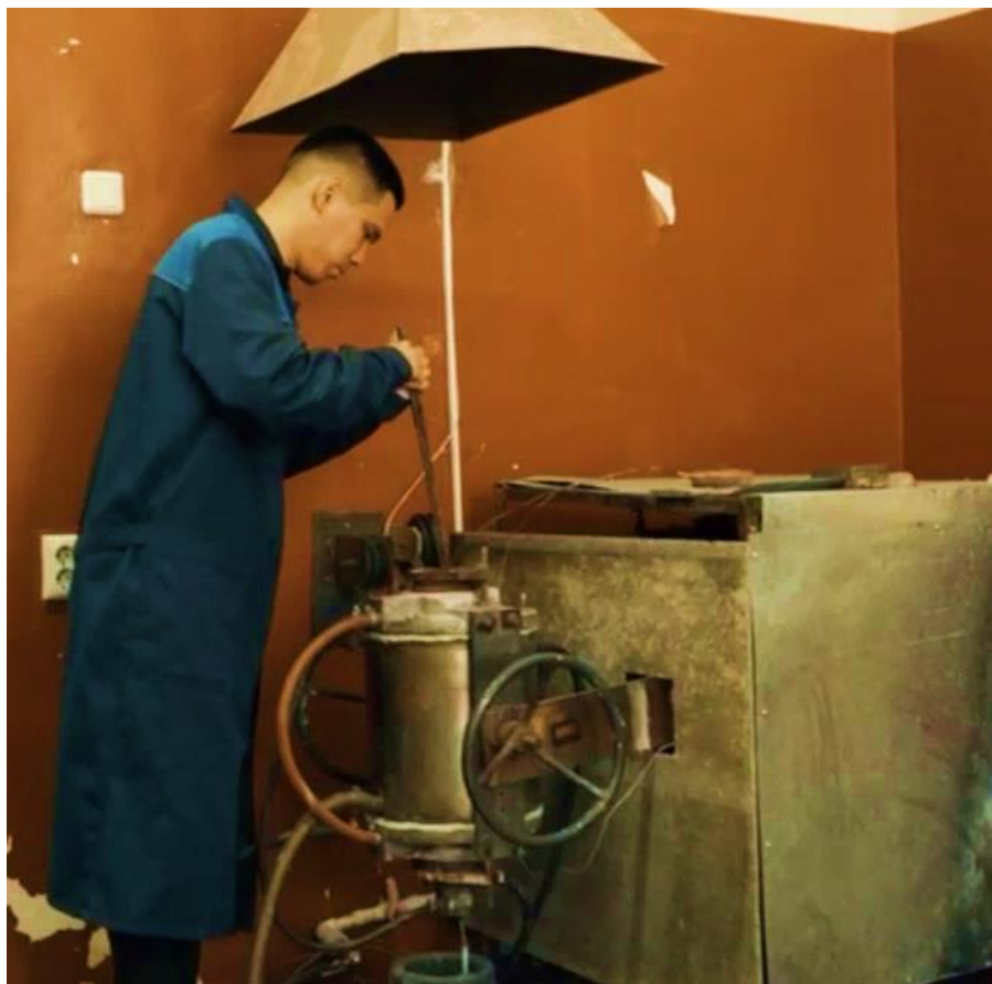
Сурет 4.2 – Жоғары температуралы зертханалық Тамман пешінде жұмыс үрдісі
