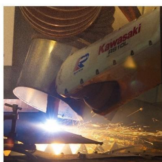
Процесс напыления: плазмотроп движется по 3D-траектории на фиксированном (по оси z) расстоянии от поверхности плиты
