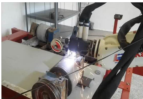
а – робот перемещает микроплазматрон вдоль поверхности вращающейся цилиндрической детали
