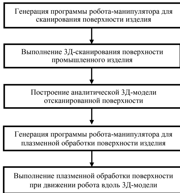
Рисунок 2.6 – Блок-схема процесса роботизированного МПН покрытий, включающая этап предварительного 3D сканирования
