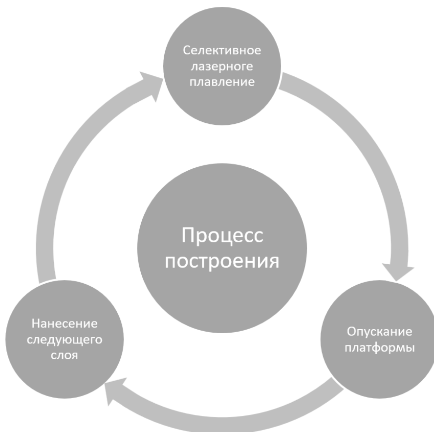
Рисунок 3 - Основной процесс производства имплантата
