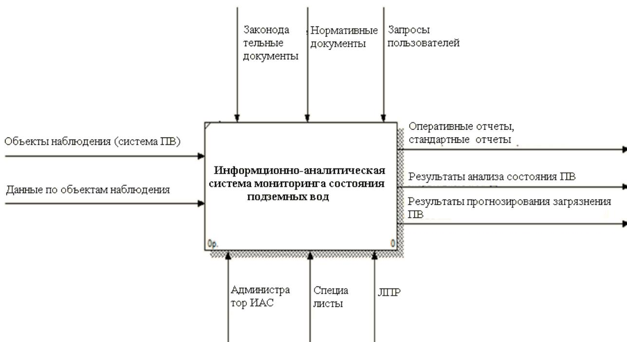
Рисунок 3.8 – Общая функциональная модель информационно-аналитической системы мониторинга состояния загрязнения подземных вод
