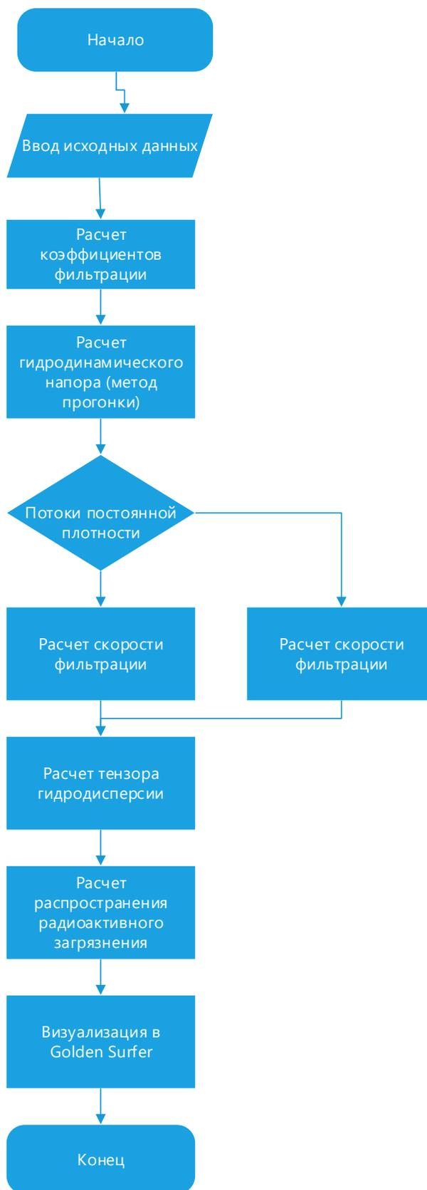
Рисунок 5 – Общий алгоритм модели
