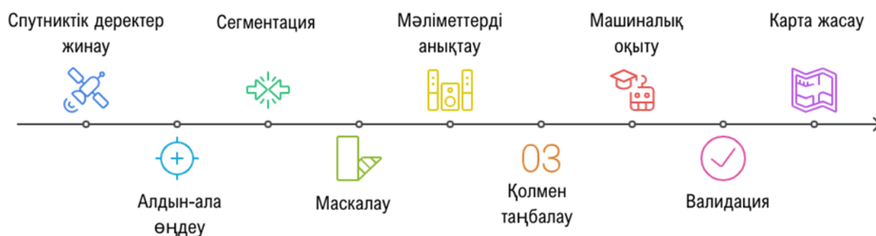
Сурет 6.1 - Спектрлік сурет және машиналық оқыту негізінде қашықтықтан зондтаудың әдістеме сұлбасы
