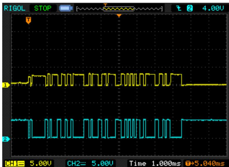
Рисунок 3.9 – Осциллограмма сигнала после второго каскада усиления приемника
