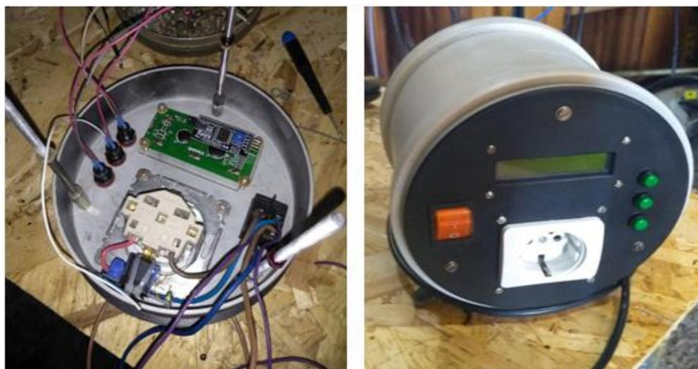
Рисунок 3.23 – Приемное устройство (задняя панель)
