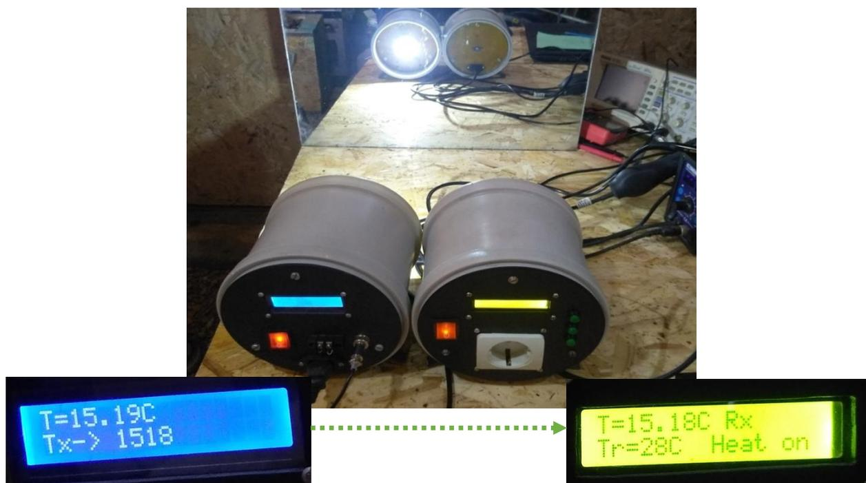
Рисунок 3.25– Демонстрация индикация системы передачи и приема значений температуры
