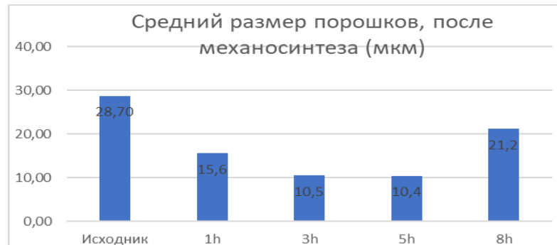
Рисунок 3. Диаграмма распределения размеров порошков, после механосинтеза
