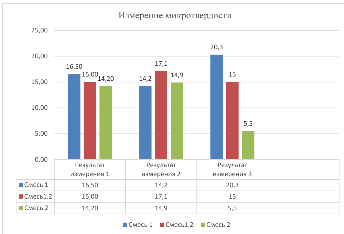
Рисунок 2. Диаграмма распределения микротвердости полимерпесчанного материала
