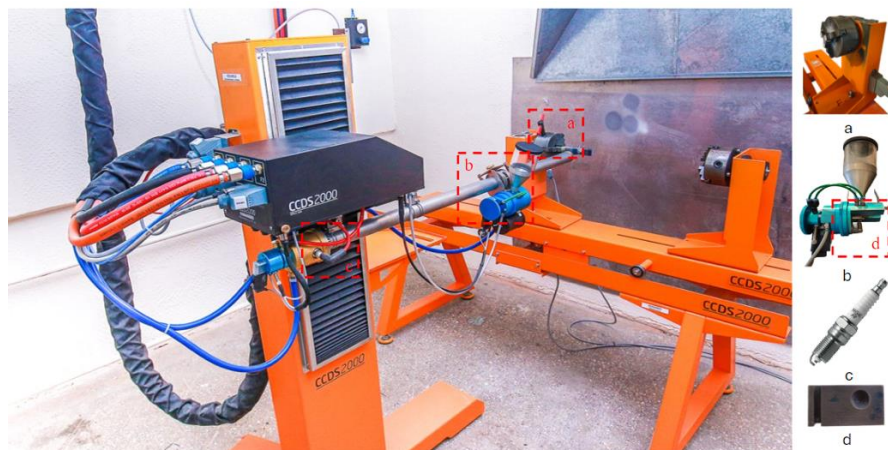
2-Сурет. CCDS2000 детонациялық қондырғысының жалпы көрінісі а) манипулятор б) ұнтақ дозаторы с) тұтану шамы d) дозалау пластинасы
