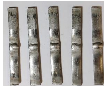
Рисунок 5. Протравленные сегменты перед испытанием на склонность к МКК
