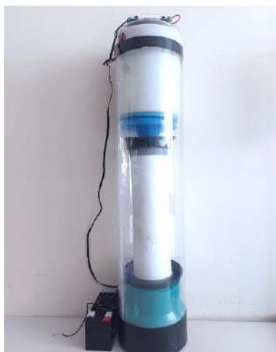
1-сурет. Ауаны конденсациялау арқылы суға айналдыратын аппарат
