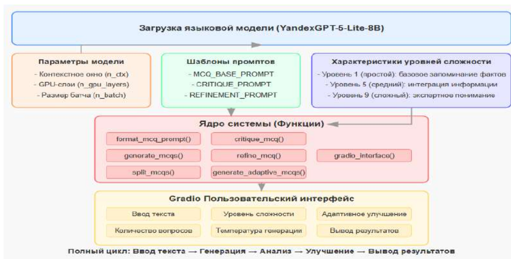
Рисунок 1 – Архитектура системы генерации тестовых заданий
