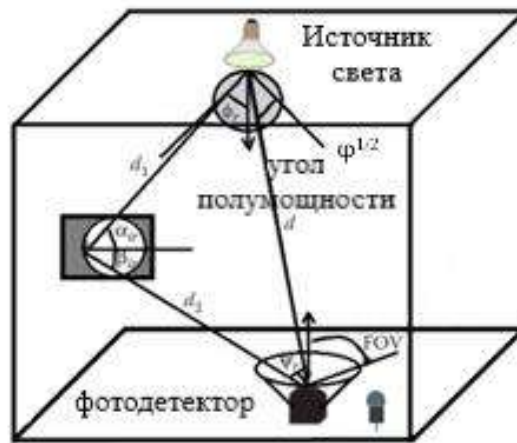
Рисунок 1 – Модель системы VLC с одной отражающей стеной и светодиодом, размещенным на потолке помещения
