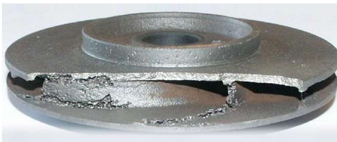
Рисунок 1 – Последствия вибрации на рабочем колесе насоса
