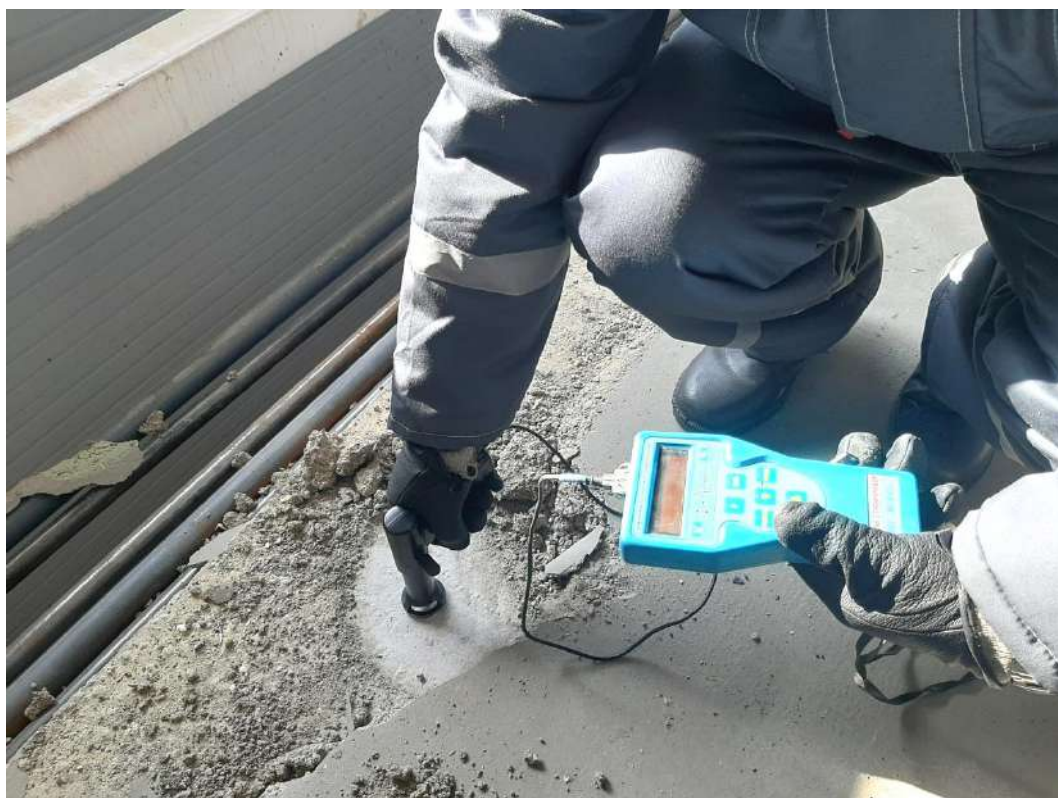
Рисунок 3 – Определение прочности бетона монолитной плиты перекрытия рабочей площадки на отметке 4.075 м
