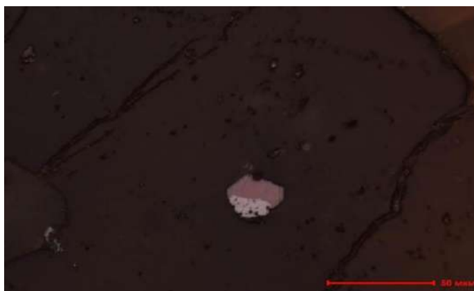
Рисунок 5 - Вторичные руды месторождения Алмады. Аншлиф.Сросток борнита и халькозина (белое)
