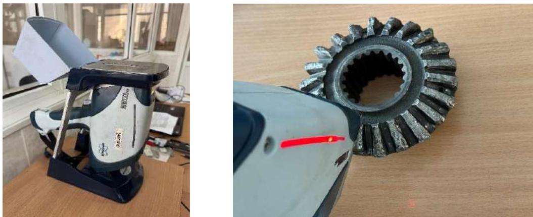
Рисунок 6 – Проведение анализа на портативном рентгенофлуоресцентном (XRF) анализаторе металлов и сплавов Bruker S1 TITAN
