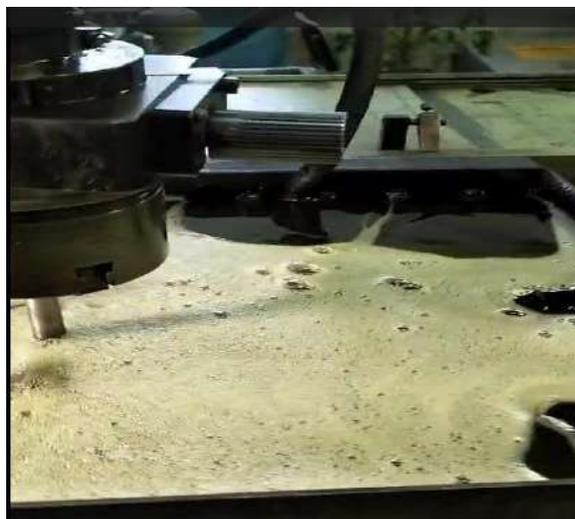
Рисунок 2- Рабочая жидкость проволочной электроэрозионного станка
