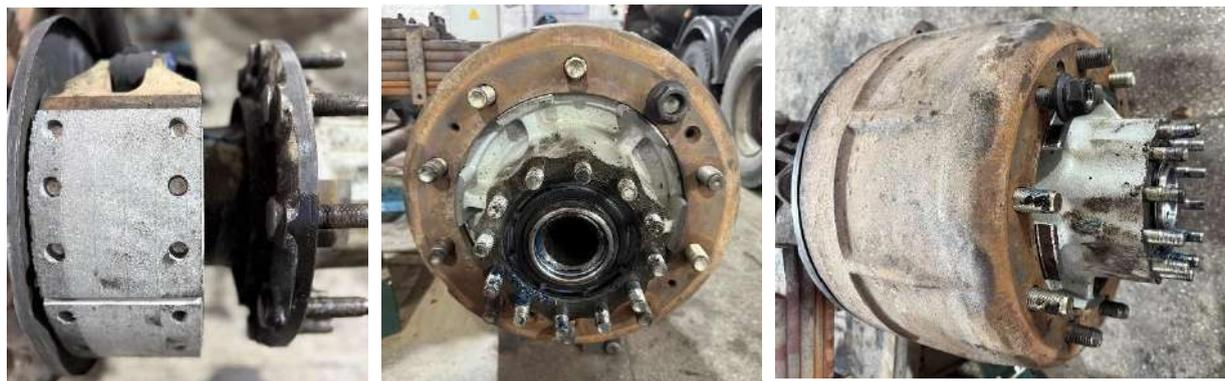
Рисунок 3 – Состояние фрикционных накладок и тормозного барабана
