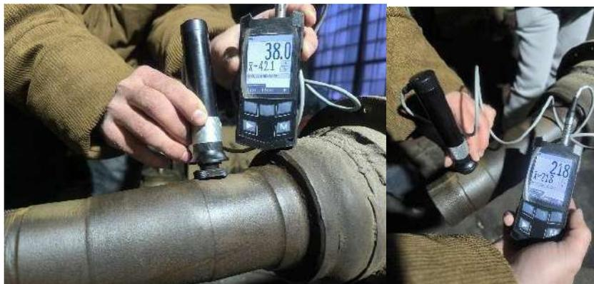
Рисунок 5 - Замер твердости посадочных мест ступичных подшипников.
