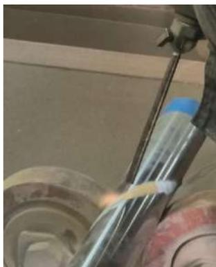
Рисунок 2 – Процесс напыления газодинамическим методом
