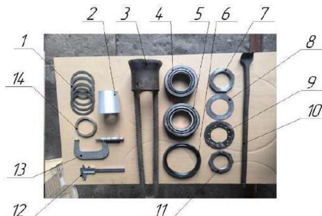
Рисунок 7 - Комплект необходимого инструмента и деталей для модернизации ступичного узла
