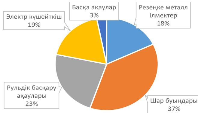
Сурет 2-VAZ-21703 алдыңғы жетекті автомобильдердің рульдік басқару элементтерінің жұмыс істемеу диаграммасы
