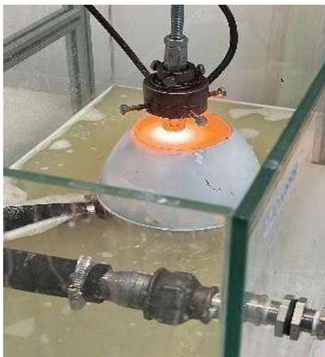
Рисунок 2 Электролититно плазменная модификация образца
