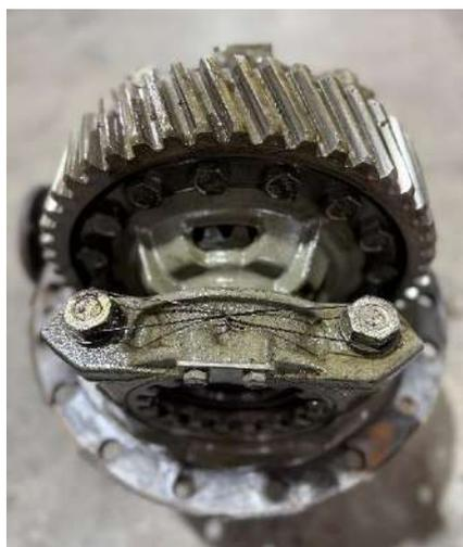
Рисунок 3 – Ведомая шестерня главной передачи
