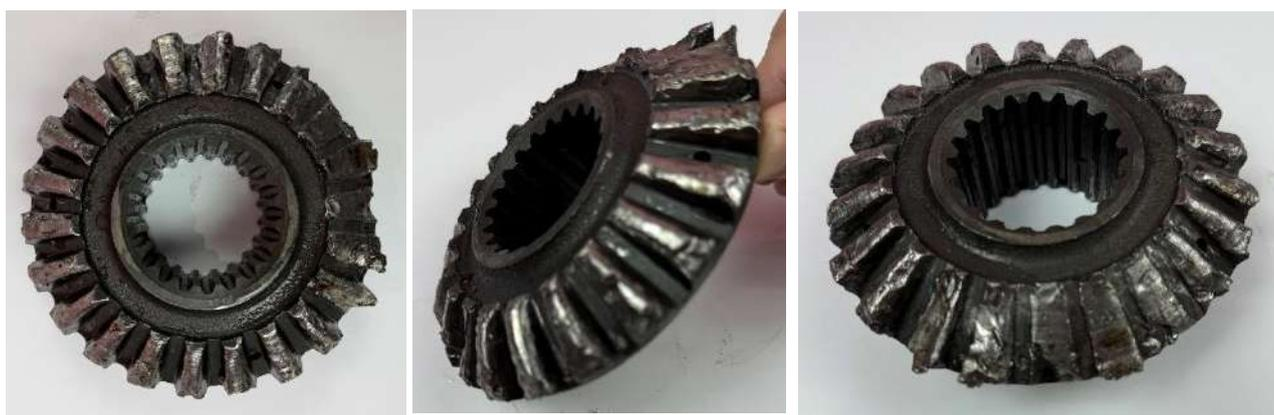
Рисунок 5 – Излом зубьев из-за воздействия динамических ударов
