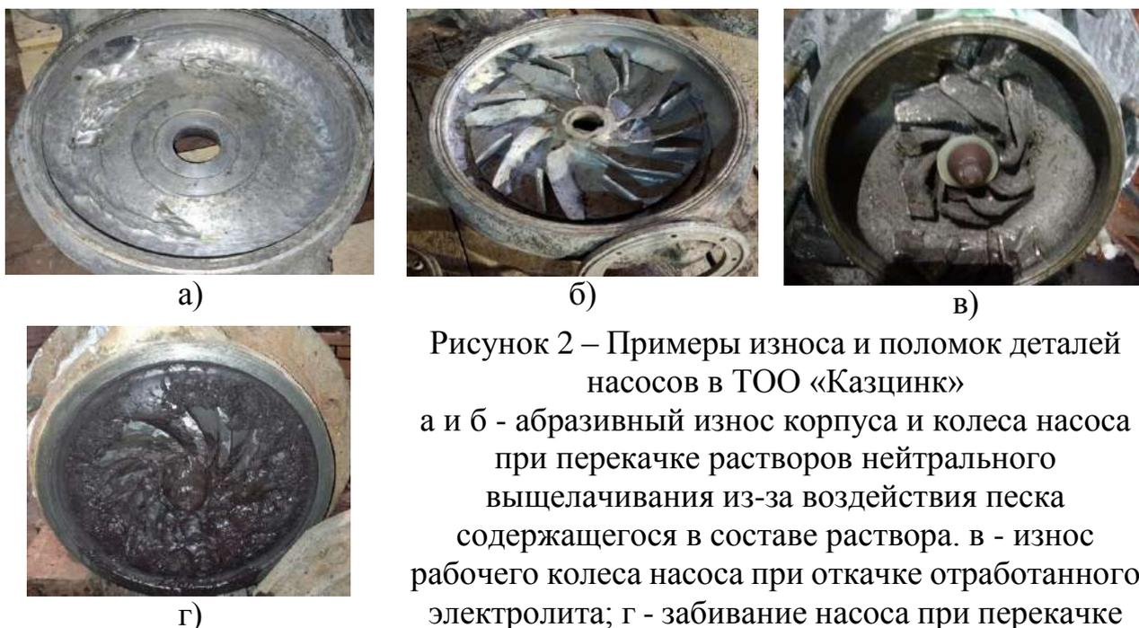
Рисунок 2 – Примеры износа и поломок деталей насосов в ТОО «Казцинк»
