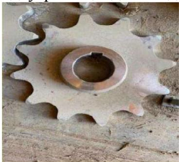
а) Конвейер жұлдызшасы
