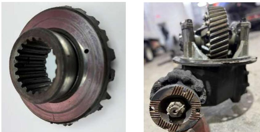
Рисунок 4 – Шестерня привода полуоси и фланец ведущего вала шестерни главной передачи
