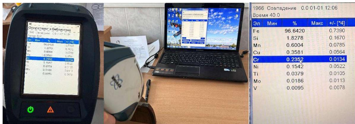
Рисунок 6 – Результаты анализа элементного состава исследуемого материала тормозного барабана
