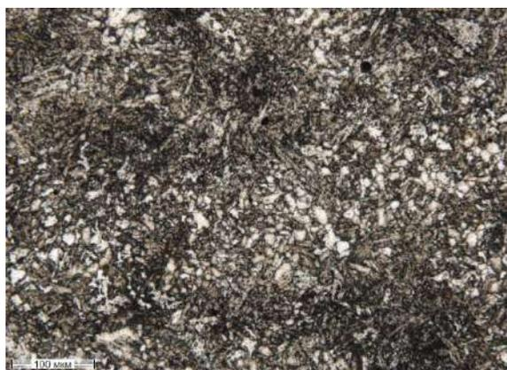
Рисунок 4. Микроструктура стали 14X17H2 после ЭПМ
