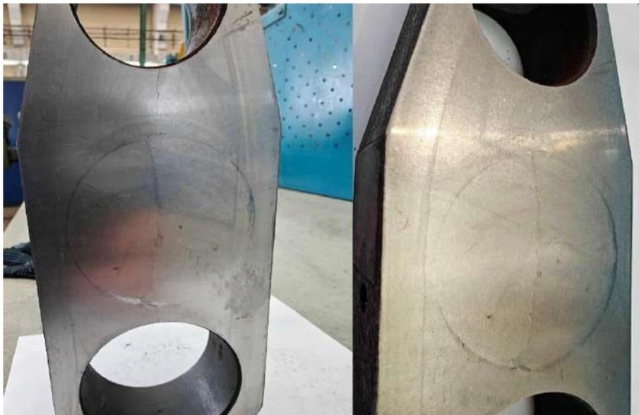
Рисунок 2 – Пример износа шибера
