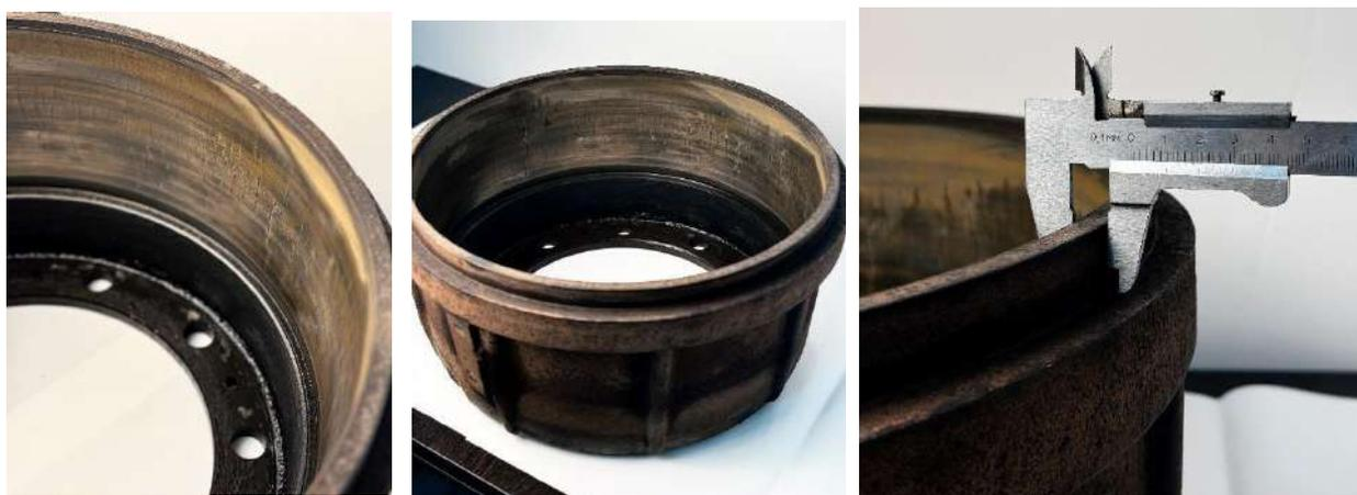
Рисунок 4 – Анализ изменения характера рабочих поверхностей тормозного барабана
