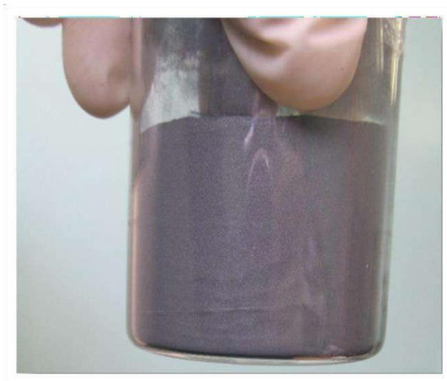
Рисунок 1 – Порошок технического бериллия
