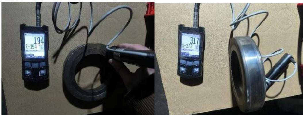
Рисунок 6 - Замер твердостей кольца опорного манжеты ступицы
