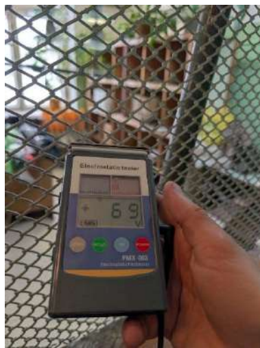
Рисунок 3. Измерение статического заряда около металлоконструкции
