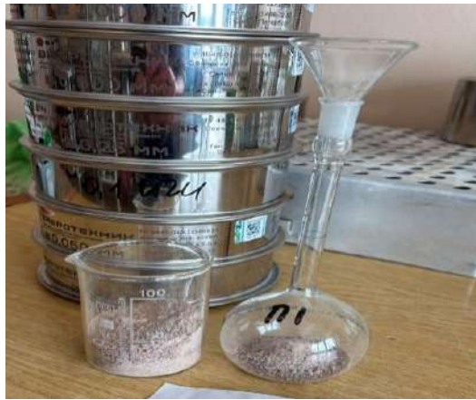
Рисунок 1. Определение гранулометрического состава грунта
