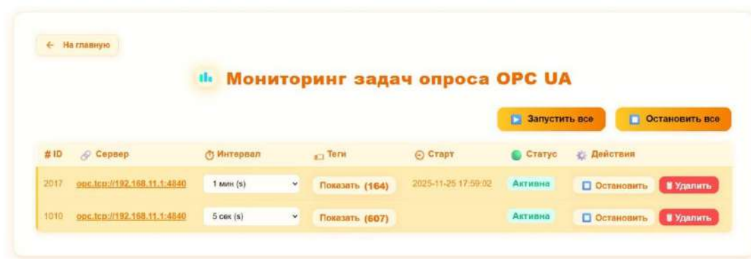
Рисунок 1. Окно модуля «Задачи опроса PLC»
