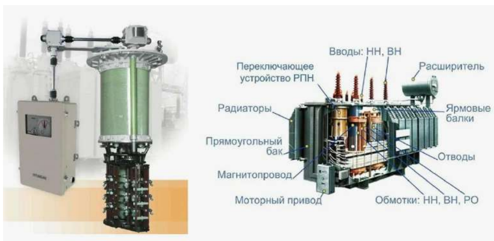
Рисунок 3. Фото силового трансформатора с устройством регулирования напряжения под нагрузкой (РПН).
