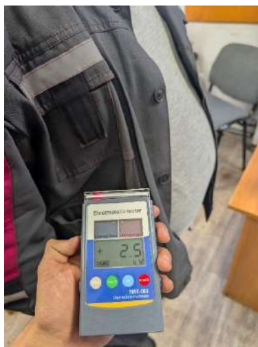
Рисунок 4. Измерение статического заряда Одежда (роба на человеке)
