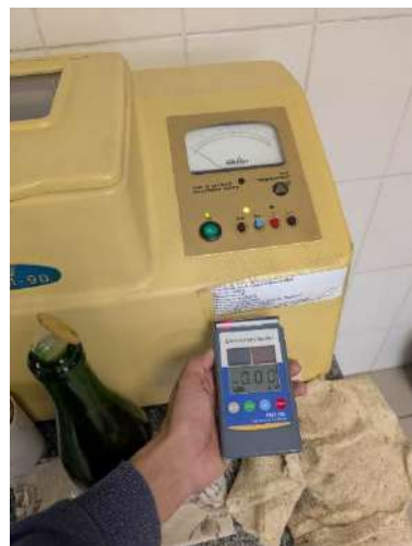
Рисунок 5. Измерение статического заряда около Центрифуги М-90
