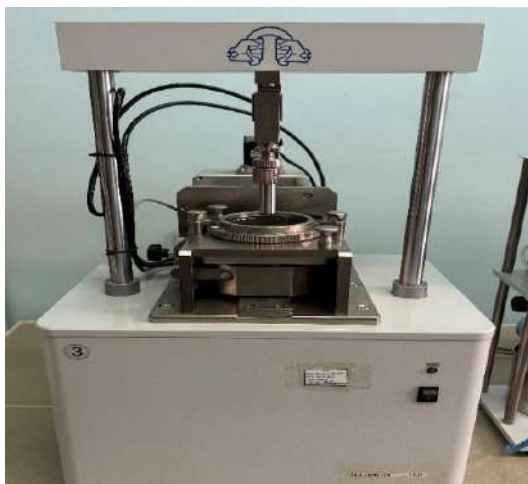
Рисунок 2. Прибор одноплоскостного среза (лабораторная установка)
