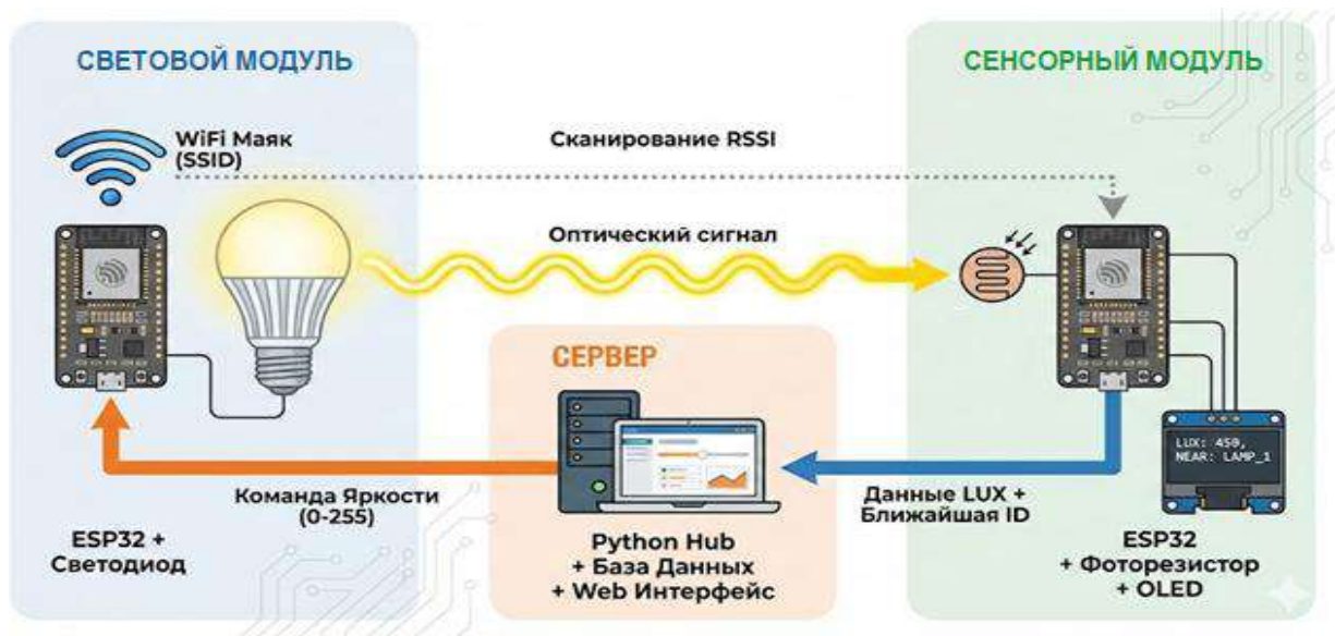
Рисунок 1. Архитектуры системы управления освещением
