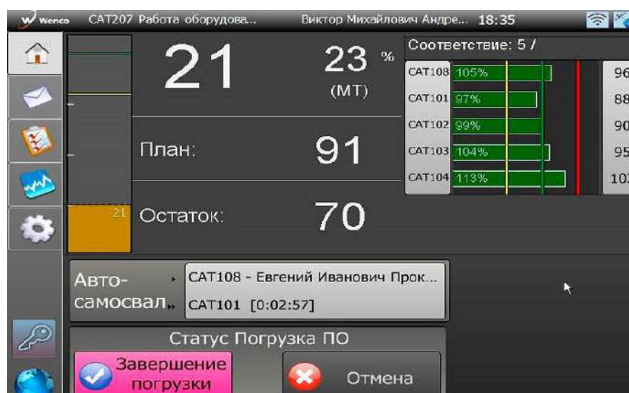
Рисунок 2. Система контроля полноты загрузки самосвала на основе анализа данных датчиков давления
