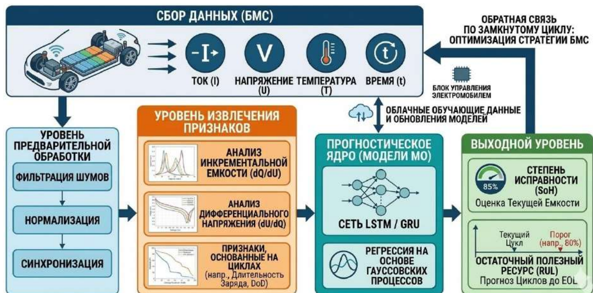
Рисунок 1 — Архитектура системы прогнозирования остаточного ресурса (RUL) литий-ионной аккумуляторной батареи электромобиля
