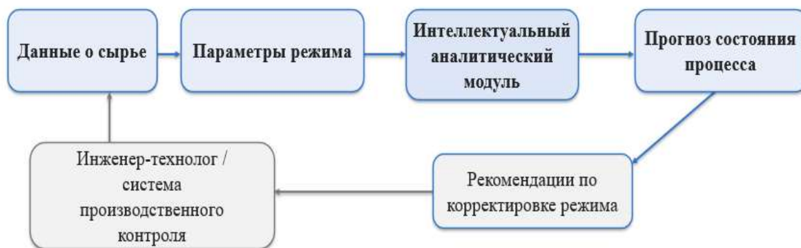
Рисунок 1. Концептуальная схема интеллектуальной поддержки управления процессами выщелачивания
