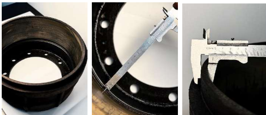
Рисунок 3. Испытуемый образец тормозного барабана
