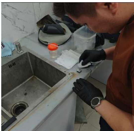
а) травление образца для выявления микроструктуры;
