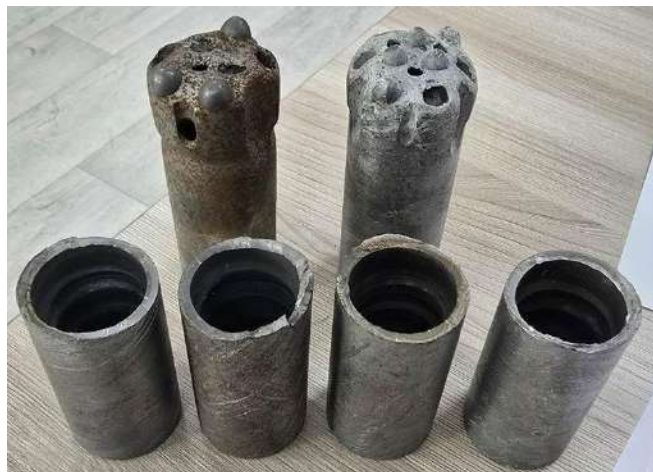
Рисунок 2. Изношенные буровые коронки (вверху) и повреждённые участки буровых штанг (внизу)
