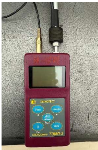
Рисунок 1. Твердомер электронный малогабаритный переносной ТЕМП-2
