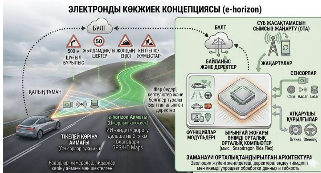
Сурет 3. "Электрондық көкжиек" (e-horizon) концепциясы
