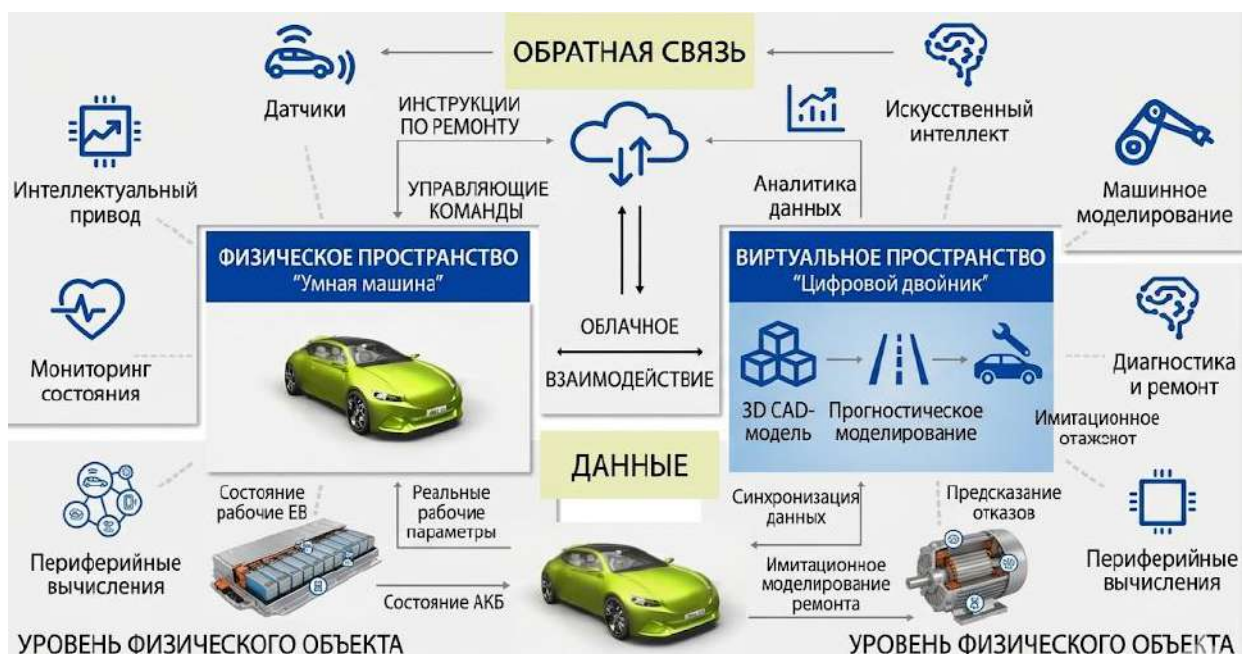
Рисунок 1. Архитектура цифрового двойника электроавтомобиля для задач ремонта
