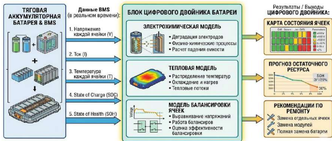
Рисунок 2. Структура цифрового двойника тяговой батареи электромобиля
