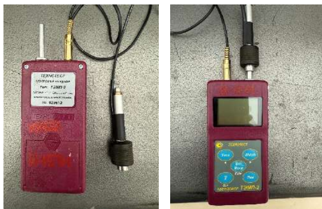
Рисунок 2. Твердомер электронный малогабаритный переносной ТЕМП-2
