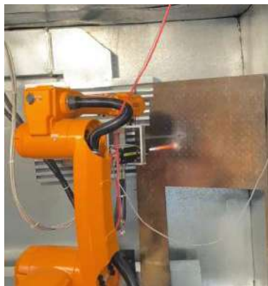
Рисунок 1. Оборудование для высокоскоростного газопламенного напыления JP-5000
