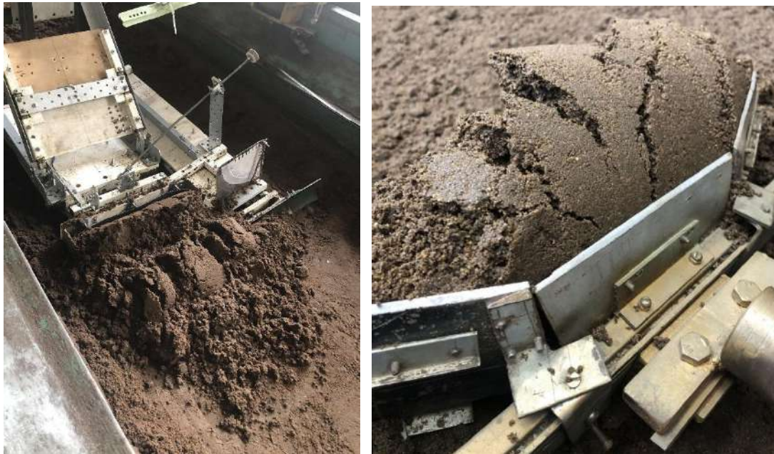
Рисунок 4. Процесс стружкообразования: а) с тонкой стружкой грунта ( 0,1H_{отв} ); б) При рациональной толщине стружки 0,15 H_{отв}
