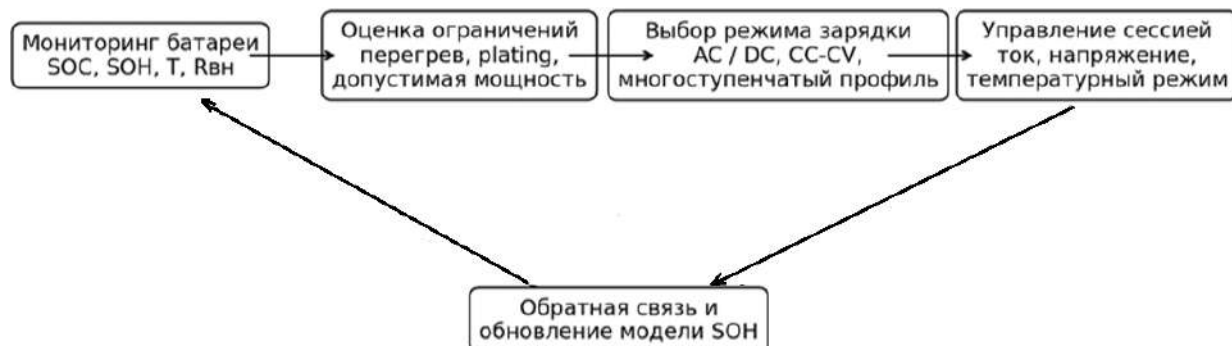
Рисунок 1. Схема адаптивной зарядки на основе мониторинга состояния аккумуляторной батареи
