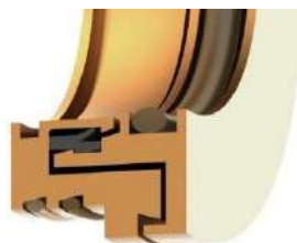
Рисунок 2. Лабиринтное уплотнение ступичного узла сельскохозяйственной техники
