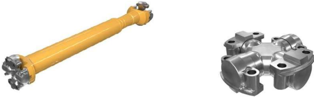
Рисунок 1. Карданный вал с крестовиной карьерного самосвала CAT 793D
