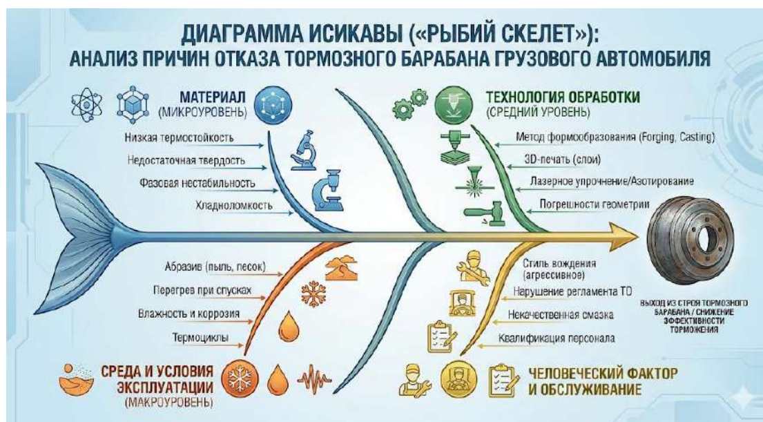
Рисунок 1. Диаграмма Исикавы причин отказов элементов тормозных систем МАТЕРИАЛЫ И МЕТОДЫ ИССЛЕДОВАНИЯ
