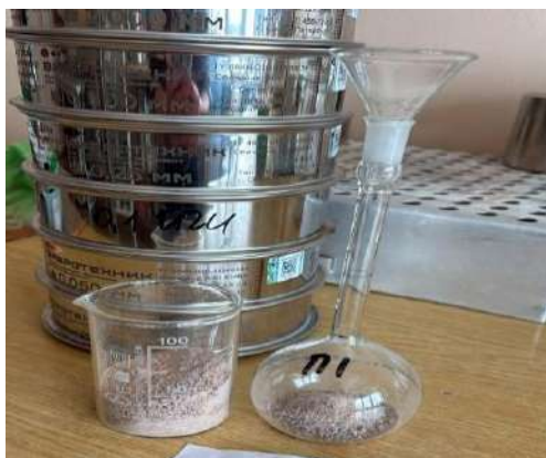
Рисунок 1. Определение гранулометрического состава грунта
