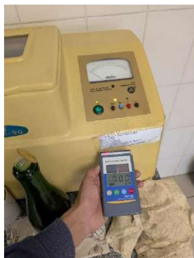
Рисунок 5. Измерение статического заряда около Центрифуги М-90
