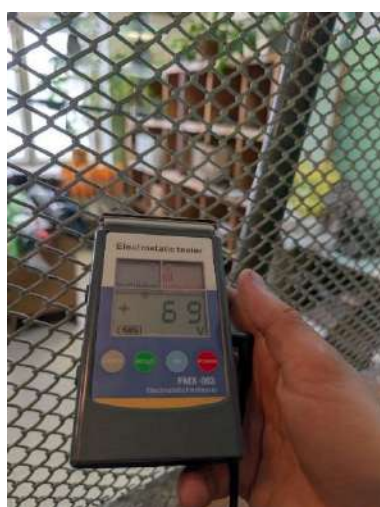
Рисунок 3. Измерение статического заряда около металлоконструкции
