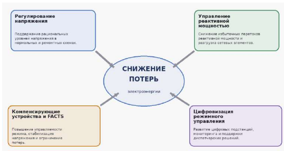
Рисунок 2. Основные направления снижения потерь электроэнергии
