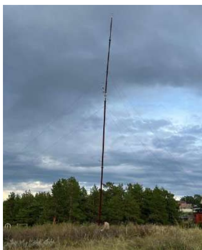
Рисунок 1. Метеомачта на базе кампуса «Простор»
