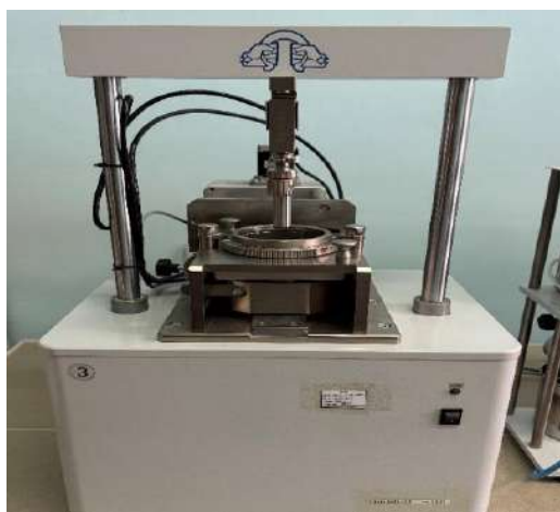
Рисунок 2. Прибор одноплоскостного среза (лабораторная установка)
