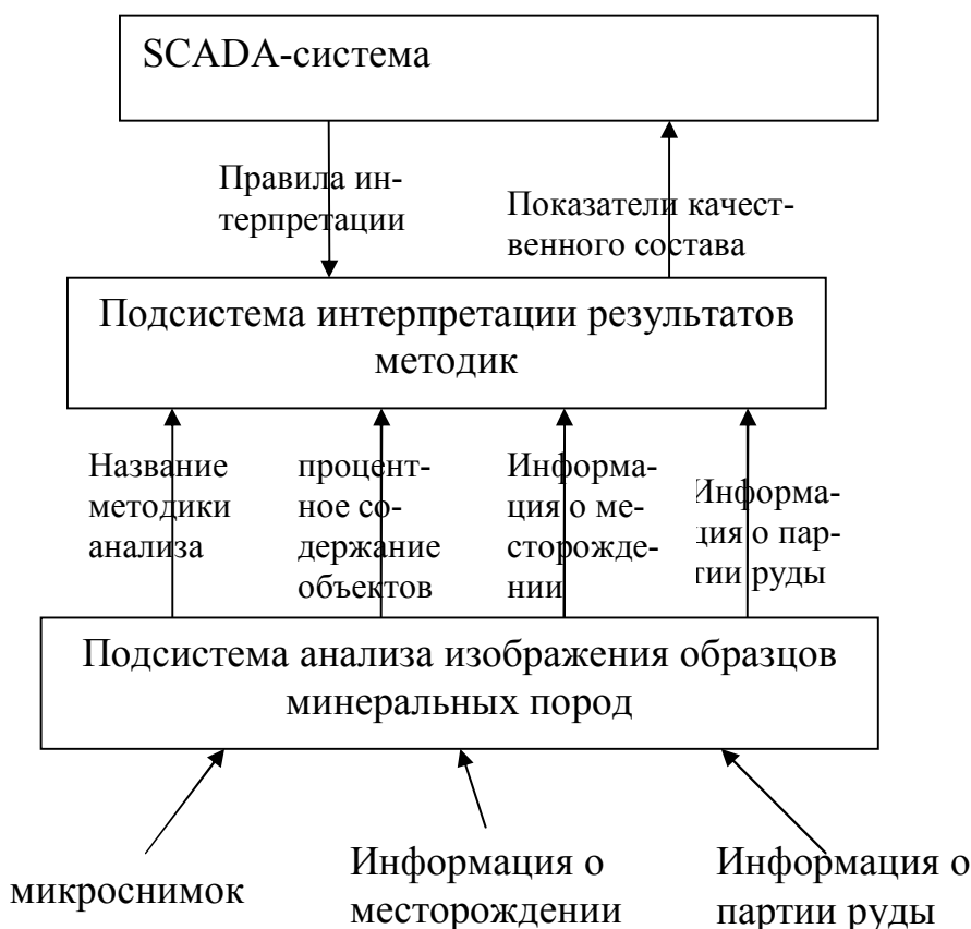
Рисунок 4 – схема потоков информации в автоматизированной системе обработки изображения для оценки качественного состава минеральных пород
