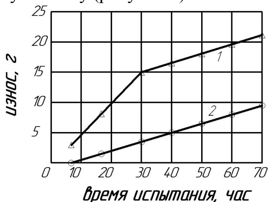
Рисунок 5 – Зависимость износа обычных (1) и науглероженных (2) шаров от времени испытания
