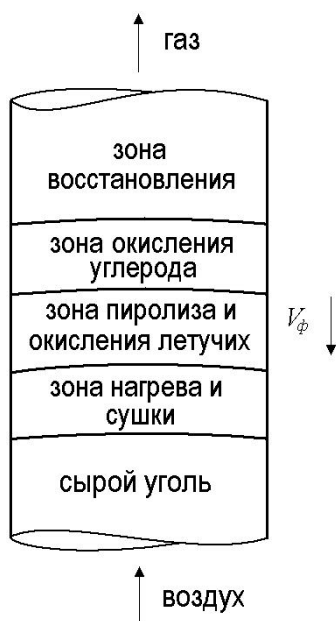
Рисунок 1 - Схема слоевого газификатора
