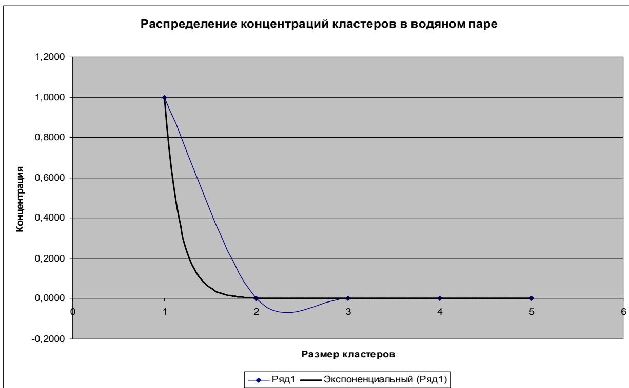
Рисунок 7 – Распределение концентраций кластеров в водяном паре при давлении P=0,11 МПа, и температуре T=398 К - измеренные значения
