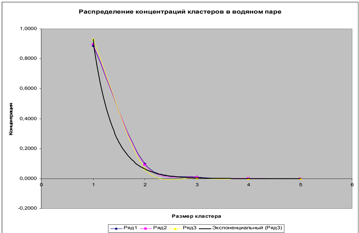
Рисунок 3 – Распределение концентраций кластеров в водяном паре при давлении P=9,02 МПа, и температурах T_1=758 К (ряд 1), T_2=798 К (ряд 2), T_3=818 К (ряд 3) – измеренные значения
