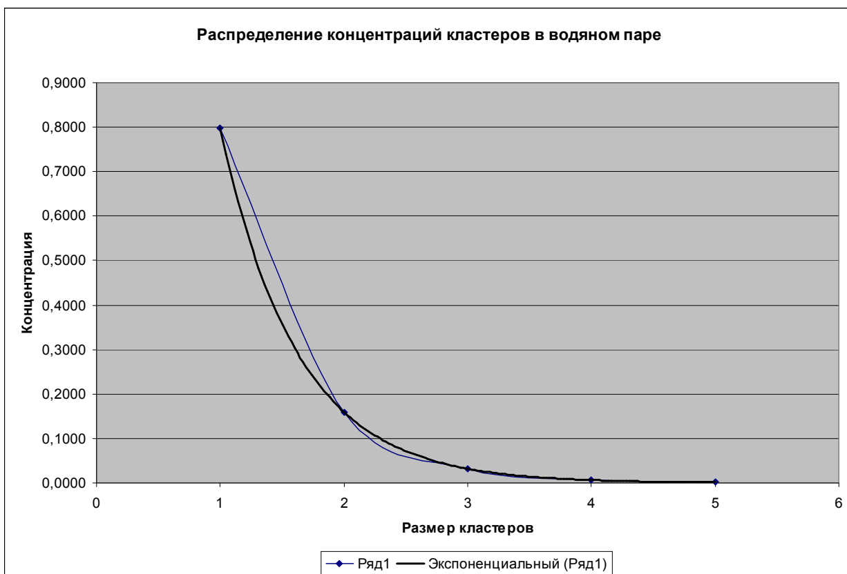
Рисунок 8 – Распределение концентраций кластеров в водяном паре при давлении P=0,17 МПа, и температуре T=398 К
