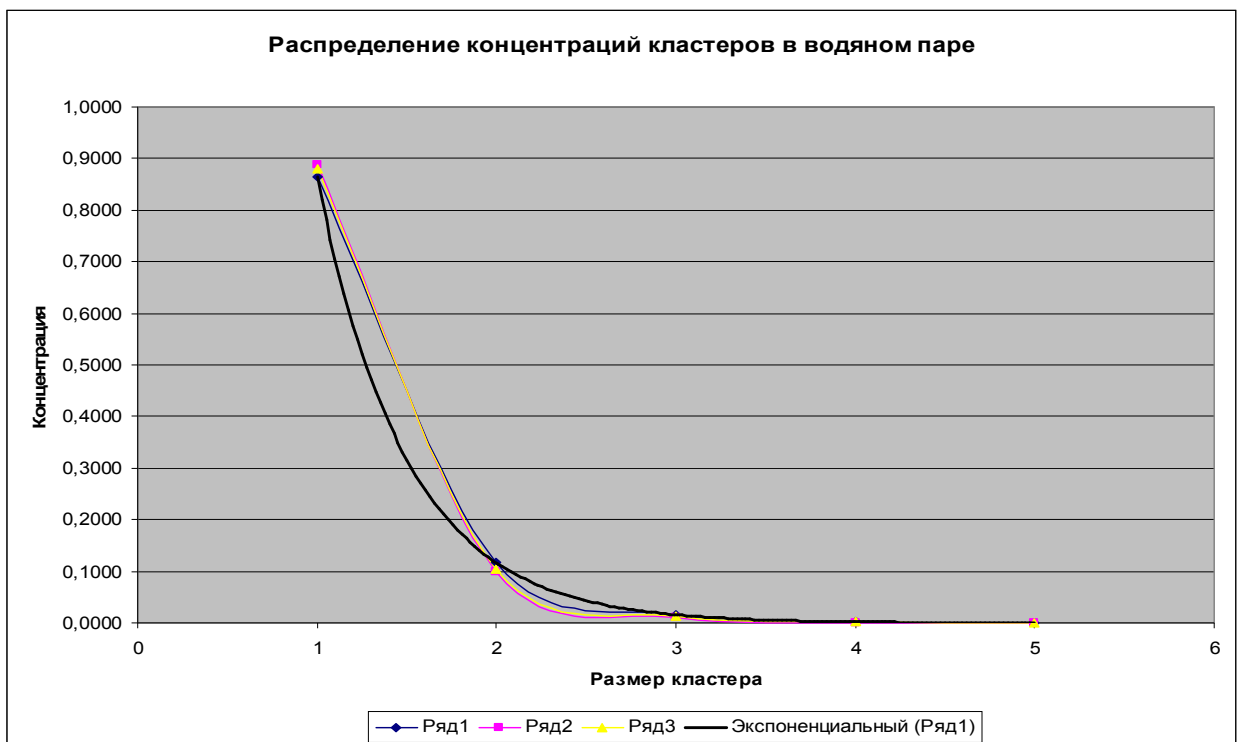
Рисунок 4 – Распределение концентраций кластеров в водяном паре при давлении P=9,31 МПа, и температурах T_1=758 К (ряд 1), T_2=798 К (ряд 2), T_3=818 К (ряд 3)
