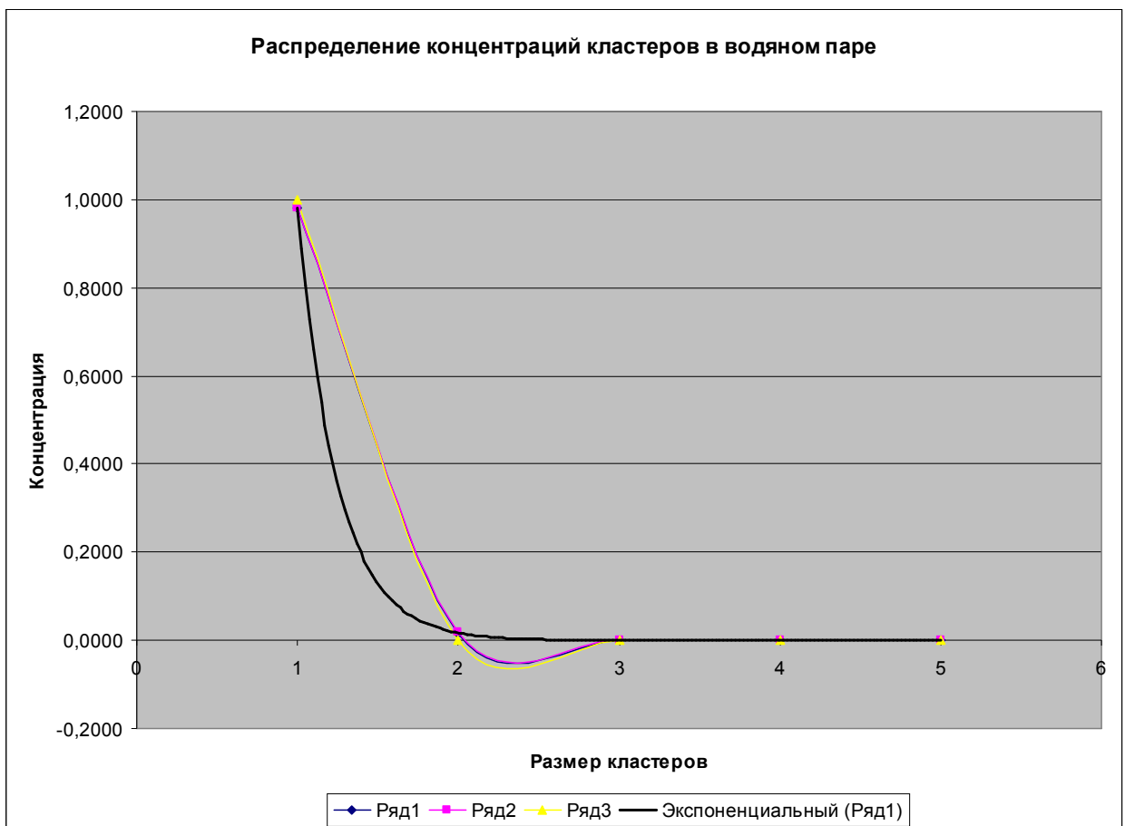
Рисунок 6 – Распределение концентраций кластеров в водяном паре при давлении P=1,11 МПа, и температурах T_1=543 К (ряд 1), T_2=563 К (ряд 2), T_3=613 К (ряд 3) – измеренные значения
