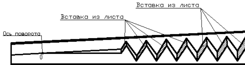
Масштаб по горизонтали в 2 раза меньше масштаба по вертикали Рисунок 6 – Принципиальная схема полуригеля после распуска и сварки
