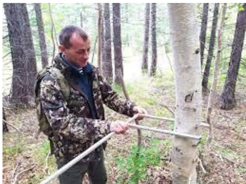
3 сурет – Диаметрді өлшеу әдісі
