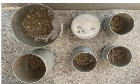
Сурет 3. Икемділіктің төменгі шегін анықтау (домалата жаю шекарасындағы ылғалдылық)
