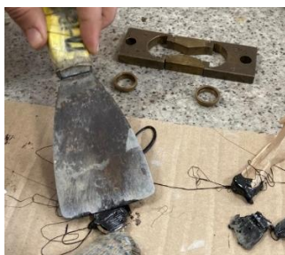
Сурет 6 Артық қорытпаны ыстық пышақпен алу үрдісі
