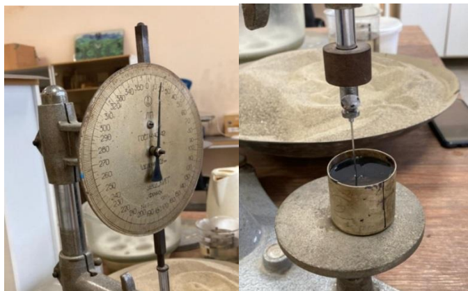
Сурет 4 Пенетрометр арқылы иненің ену тереңдігін анықтау
