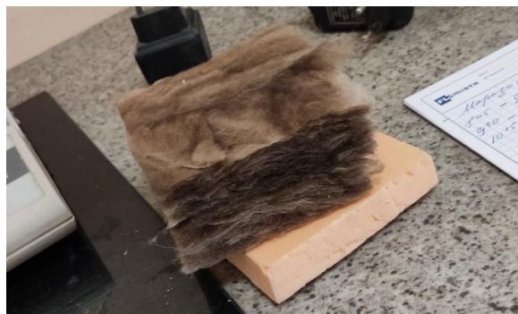
Рисунок 7 – образцы для определения коэффициента теплопроводности
