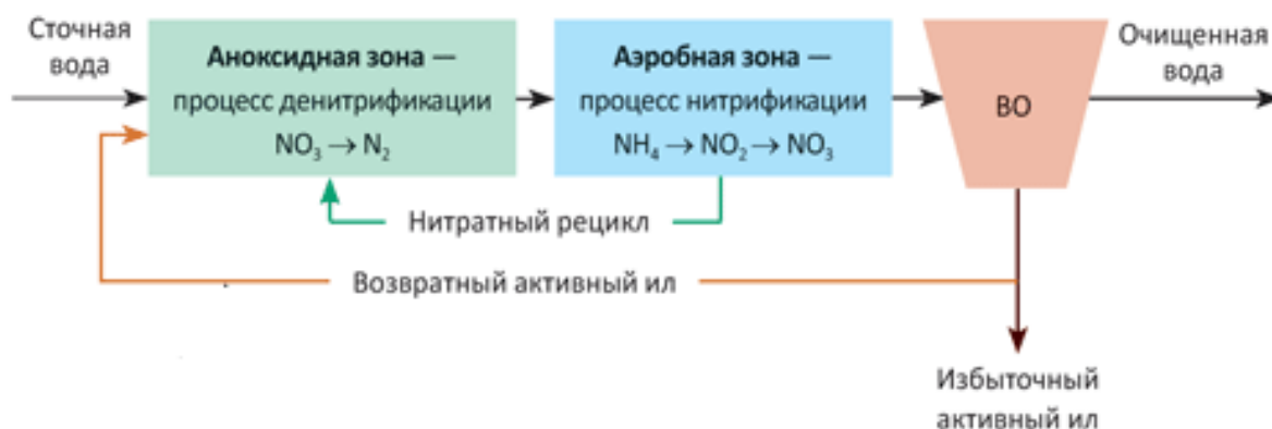
Рисунок 1 – Технология очистки городских сточных вод от азота и фосфора с предвключенной денитрификацией
