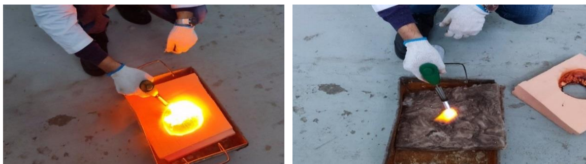
Рисунок 4 – Испытание образцов на огнестойкость
