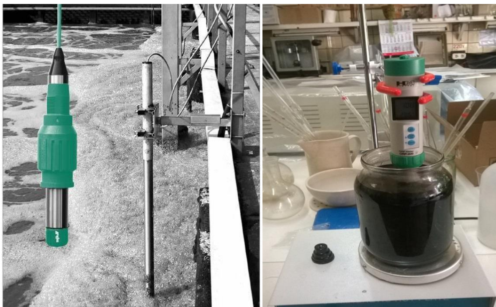
Рисунок 3 – Контроль за брожением при помощи редоксметра
