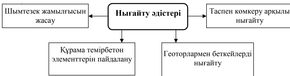
2 – сурет. Топырақ үйіндісінің беткейлерін нығайту әдістері
