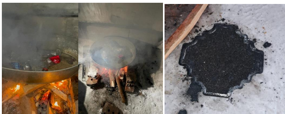
Сурет 9 – Полиэтилентерефталат қалдықтарын пайдала отырып жасалған тротуарлық (еден) плитки
