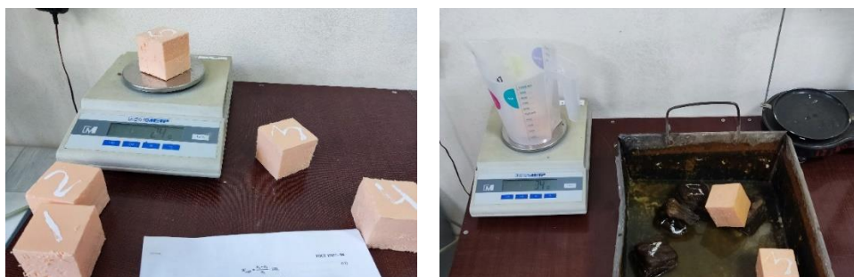
Рисунок 3 – Взвешивание образцов до погружения и после
