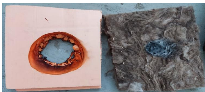
Рисунок 5 – Результат 10-ий секундного горения образцов
