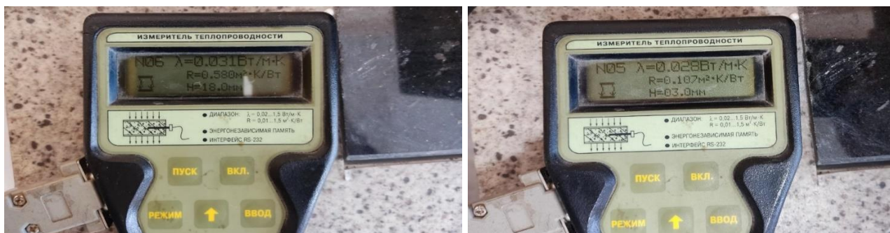
Рисунок 8 – Полученные результаты коэффициента теплопроводности для образцов из пеноплекса (слева) и минеральной ваты (справа).
