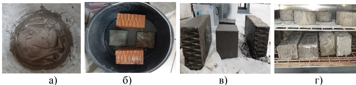
Рисунок 2 – Подготовка образцов обработанного материалом Пенетрон для испытания:
