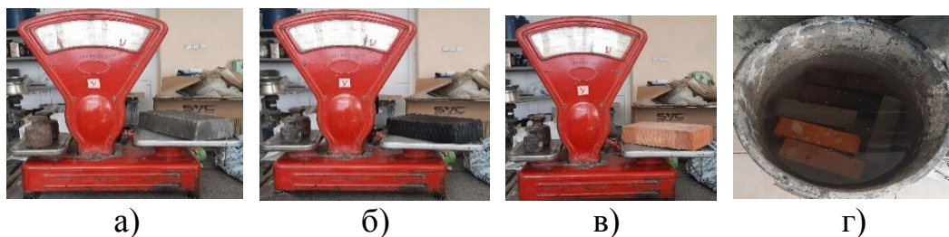
Рисунок 4 – Определение водопоглощения кирпичей:
