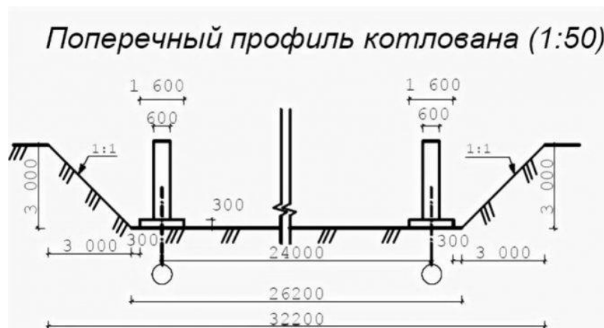
Рисунок 1 - Расчет объемов земляных работ
