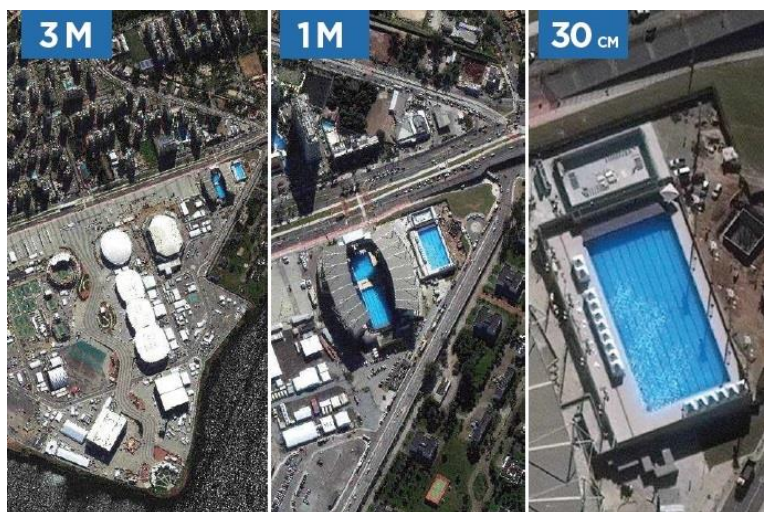
Сурет 2. Ғарыш суреттерінің кеңістіктік ажыратымдылығын салыстыруды көрсету (бассейннің өлшемі 50м x 25 м)
