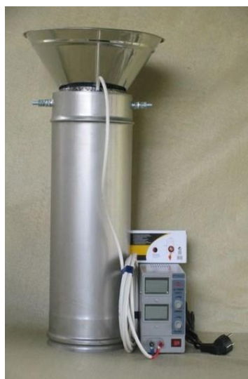
Рис.1. Установка для предпосевной стимулирующей обработки семян «ЦИКЛОН-7-3у»
