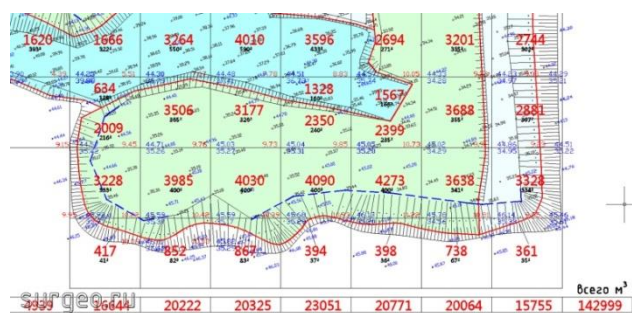
Рисунок 2 - Расчет объемов земляных работ
