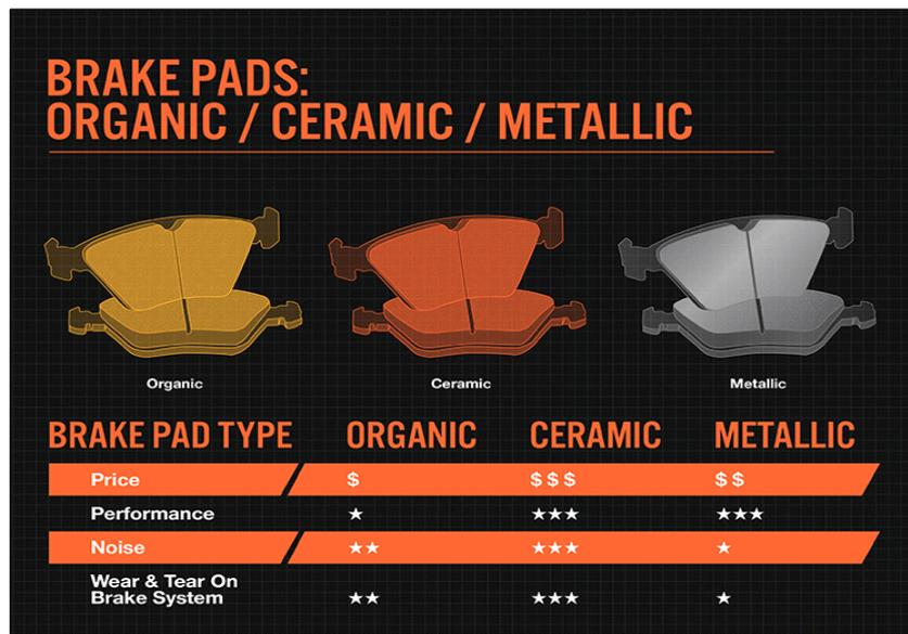
Рис.4 Сравнительный анализ тормозных колодок
