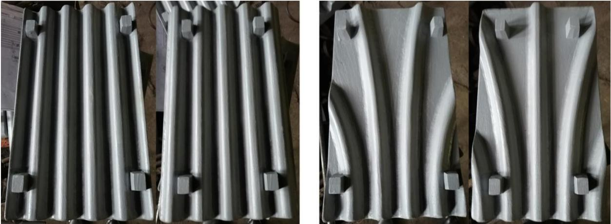
Рисунок 5 - Модельная оснастка дробящих плит со стандартным и предлагаемым рифлением
