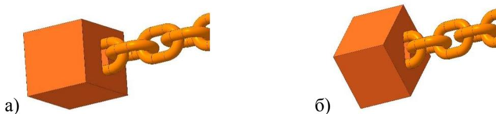
Рисунок 3 – Неразъемное соединение бойков с гибкими тягами с расположением паза вдоль ребер (а) или по диагонали (б) грани
