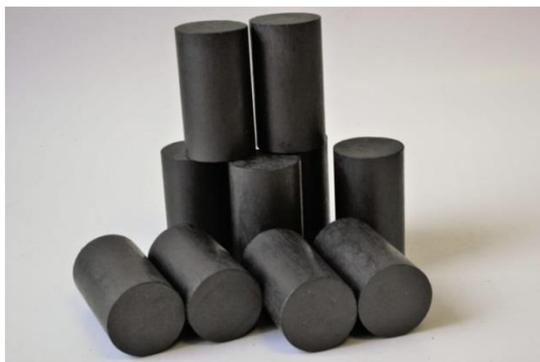
Рисунок 2 – Фторопласт Ф4К20
