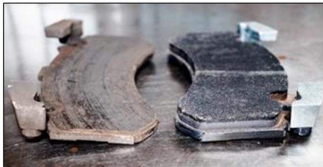
Рис.1. Износ тормозных колодок
