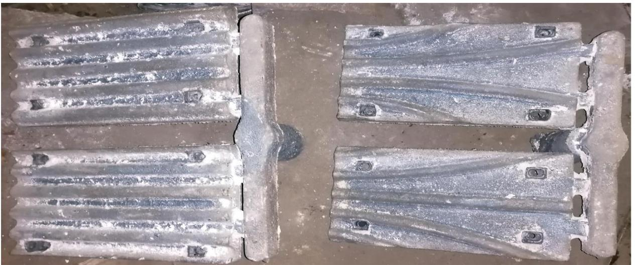
Рисунок 6 - Дробящие плиты со стандартным и предлагаемым рифлением (литниковая система не удалена)
