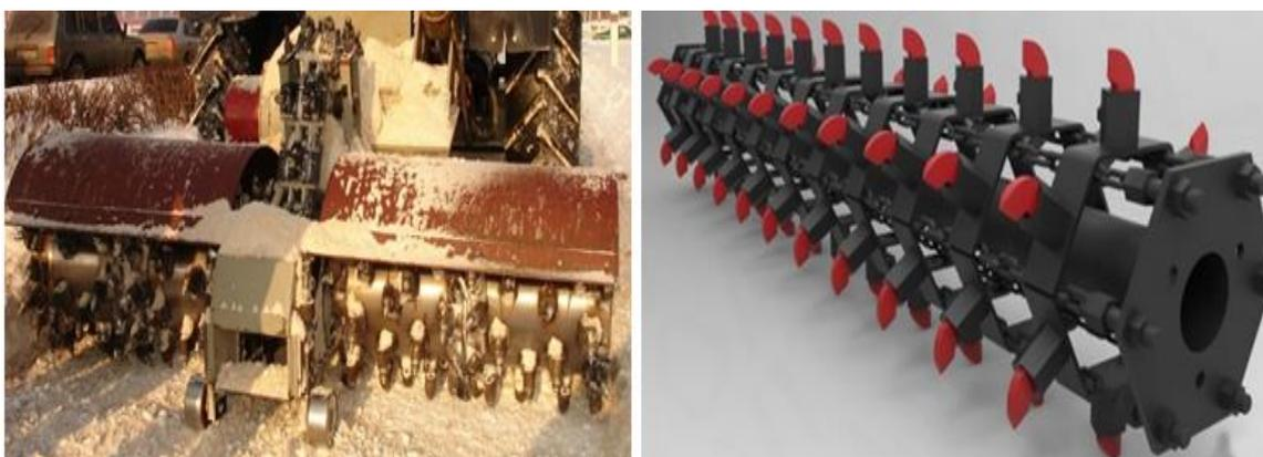
Рисунок 5 – Фрезерный жесткий и плавающий рабочий орган
