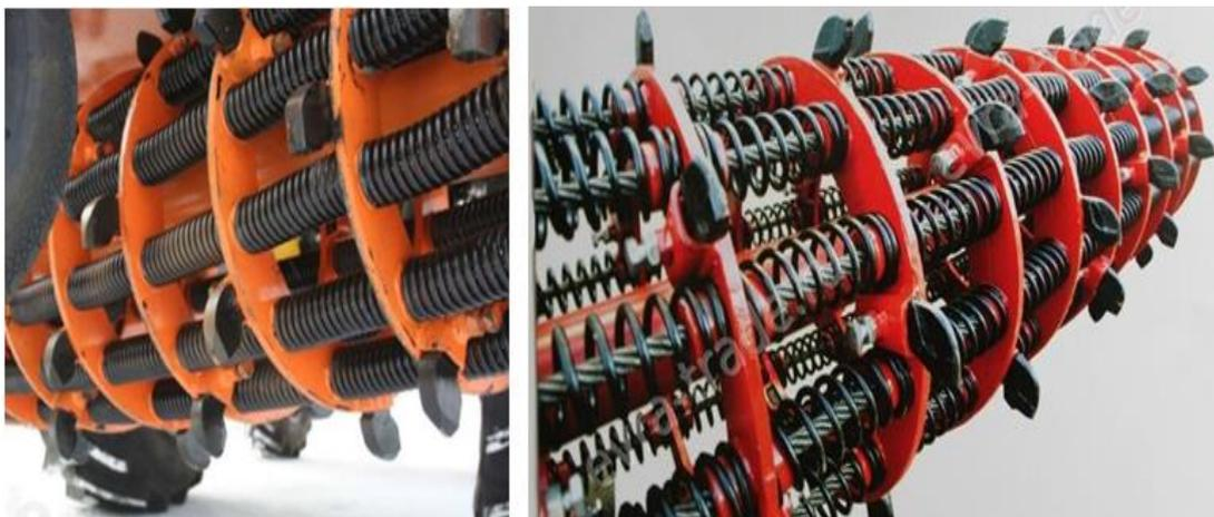
Рисунок 4 – Гибкий рабочий орган ударно-скалывающего действия
