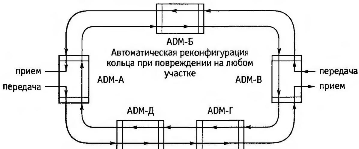
Рис 4. Двухнаправленное кольцо с защитой секций мультиплексирования
