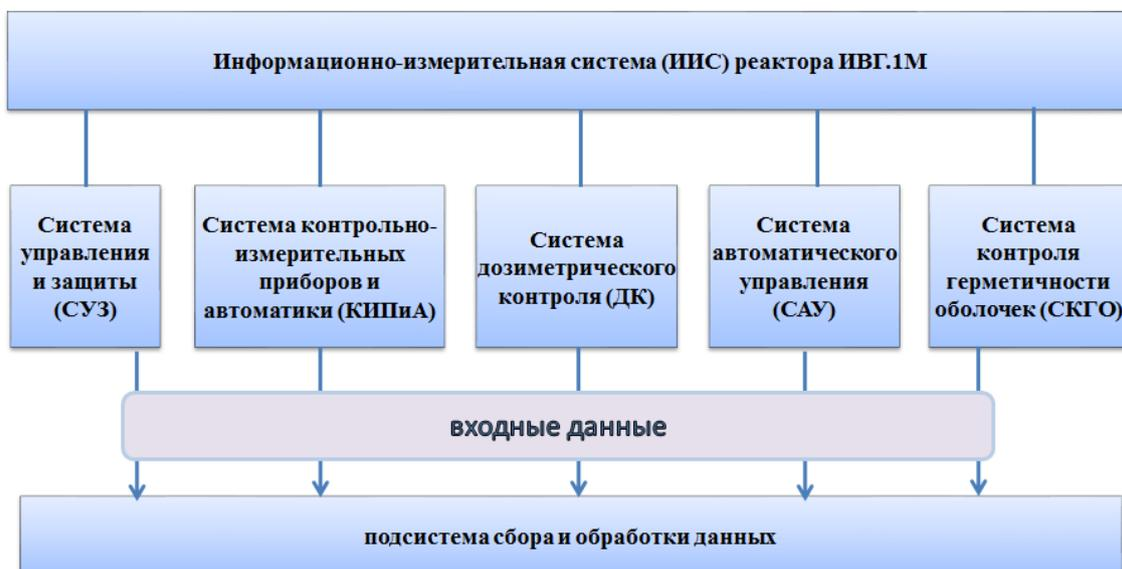
Рисунок 1 Структура информационно-измерительной системы реактора
