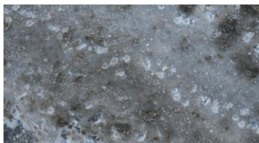
Рисунок 12 – След от ударного воздействия на ледяное покрытие (глубина лунки 8 мм) сферического бойка льдоскалывателя при минимальном (240 об/мин) вращении его рабочего органа.
