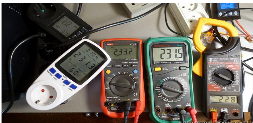
Сурет – 1. Бір вольт дәлдікке дейін өлшенген желідегі кернеу.
