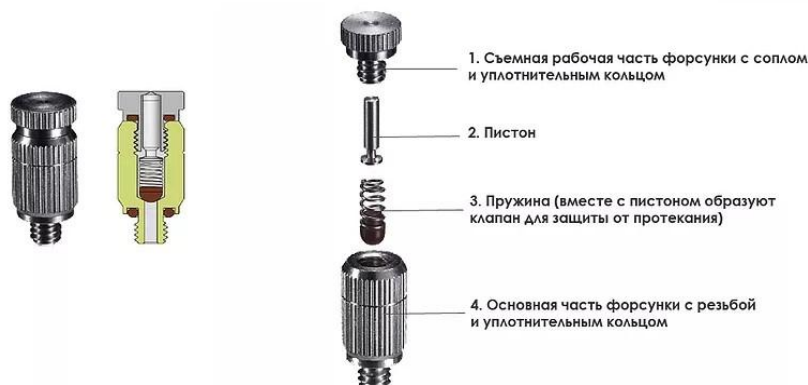
Рисунок 4 - Конструкция туманообразующей форсунки
