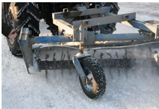
Рисунок 1 – Опытно-промышленный образец льдоскалывателя, установленный на базовой машине, в работе
