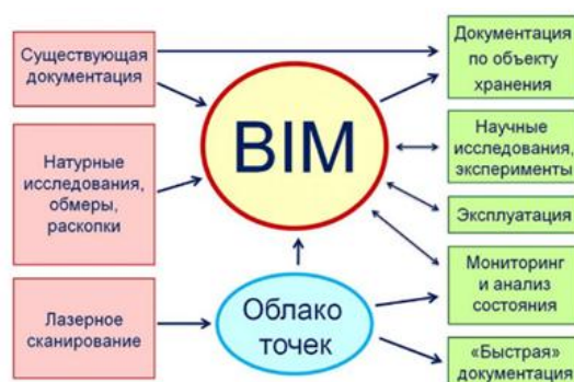
Рисунок 1- Схема взаимодействия при информационном моделировании.
