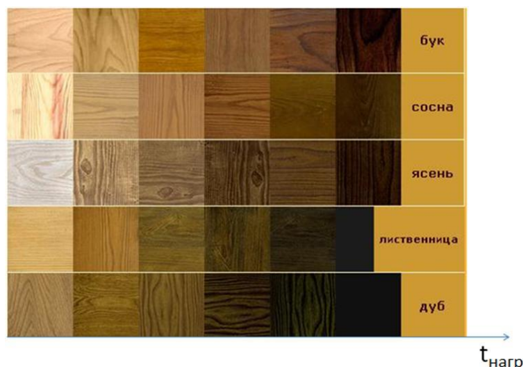
Рисунок 1 – Иллюстрация изменения цвета древесины в зависимости от температуры нагревания для разных пород древесины при термической обработке
