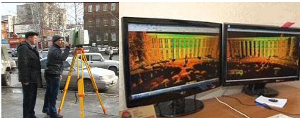
Рисунок 2 - Процесс сканирования фасада здания при помощи 3D-сканера.
