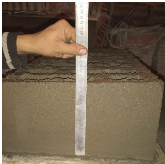
Рисунок 4 – Измерение высоты выборки пескоблоков
