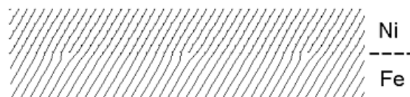
Рисунок 8 Граница биметалла Ni - Fe , показанная через визуализатор плотноупакованных рядов
