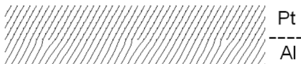
Рисунок 11 Граница раздела биметалла Pt - Al , показанная с помощью визуализатора плотноупакованных рядов
