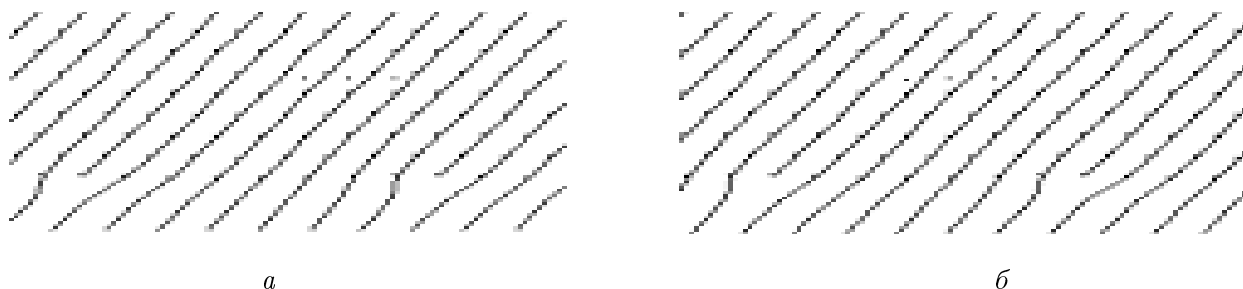
Рисунок 2 Внедрение атомов Ni в межузельное пространство никеля биметалла Ni – Al : a – межузельные атомы внедрены в ряды между дислокациями несоответствия; б – межузельные атомы внедрены вблизи экстраплоскости дислокации несоответствия
