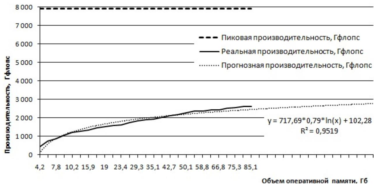
Рисунок 3 График изменения реальной производительность 6-го варианта экспериментального образца КГВС и линия тренда
