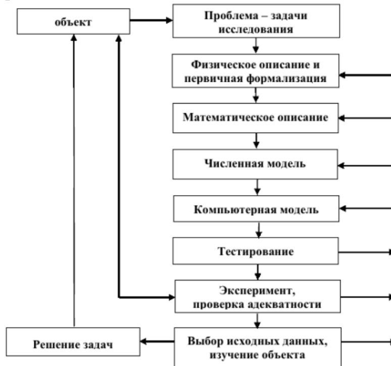
Рисунок 2 – Схема взаимосвязей этапов построения математической модели и моделирования объекта
