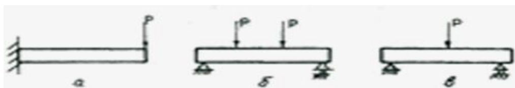
5-сурет. Үлгілерді майыстырып сынау схемалары
