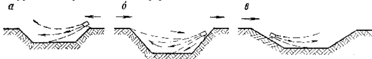
Рис. 7.20. Схемы вентиляции карьеров вентиляторной установкой.
