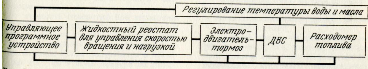
15.6 - Блок-схема автоматизированного стенда для приработки и испытания ДВС
