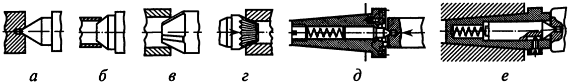
Рис. 4. Центр: а — жесткий; б — срезанный; в — специальный, с тремя узкими ленточками на кромке отверстия детали; г — поводковый, передающий крутящий момент от вдавливания рифленой поверхности при приложении к центру осевой линии; д — поводковый, передающий момент через рифления, вдавливаемые в торцевую плоскость детали; е — плавающий передний
