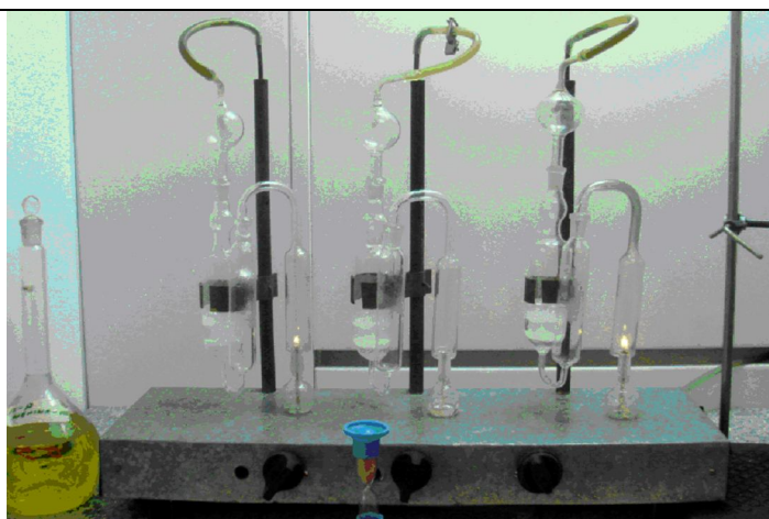
Аппарат для определения содержания серы в нефтепродуктах сжиганием в лампе, ГОСТ 19121
