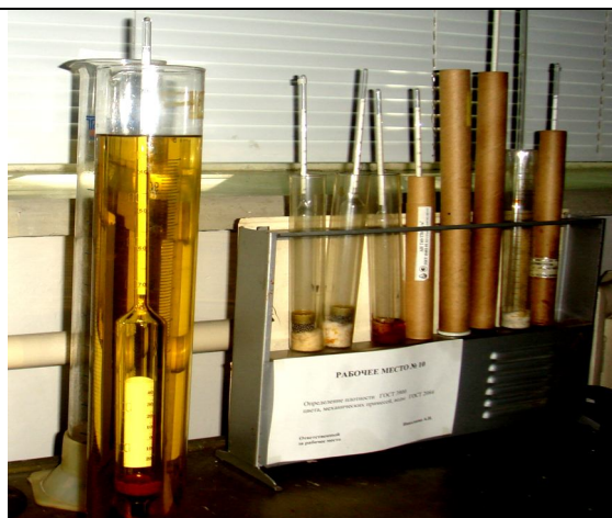
Комплект ареометров для определения плотности нефтепродуктов, ГОСТ 3900-85
