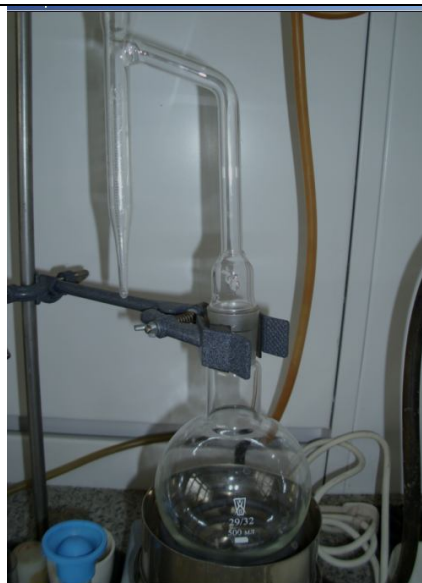
Аппарат для количественного определения воды в нефтяных, пищевых и других продуктах АКОВ-10-1 методом отгонки, ГОСТ 2477-65
