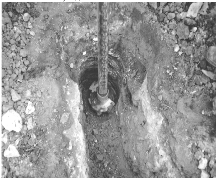
Рисунок 1 – Отбор проб земляного полотна по глубине дорожной одежды при бурении машиной УБГ 50 М
