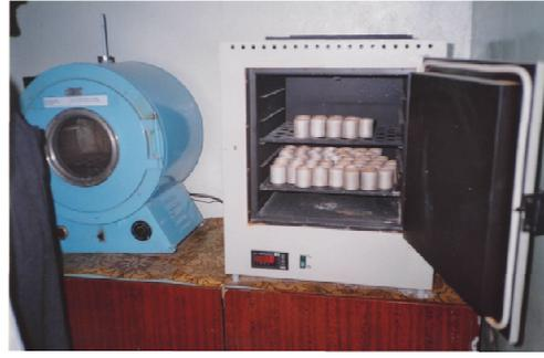
Рисунок 14 - Электрический шкаф для сушки грунтов в бюксах
