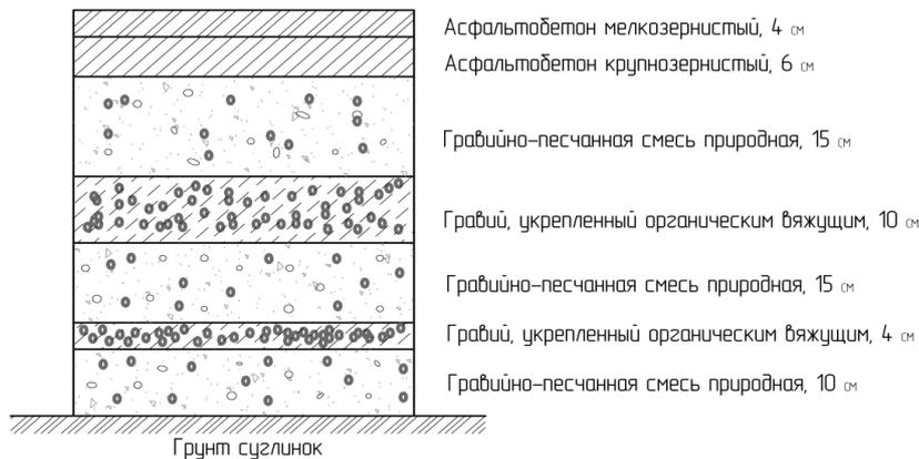
Рисунок 15 - Конструкция дорожной одежды по слоям
